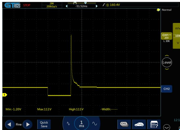
**Figura 2.50** Oscilograma inyector
