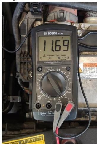
**Figura 2.31** Voltaje de referencia del sensor MAF en contacto
