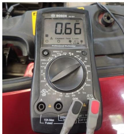
**Figura 2.37** Resistencia del sensor IAT a 55°C
