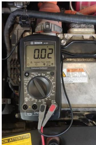
**Figura 2.30** Voltaje de masa del sensor IAT en contacto
