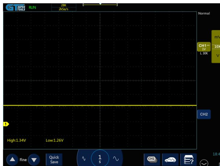
**Figura 2.24** Oscilograma del sensor MAP en RALENTÍ a 95°C
