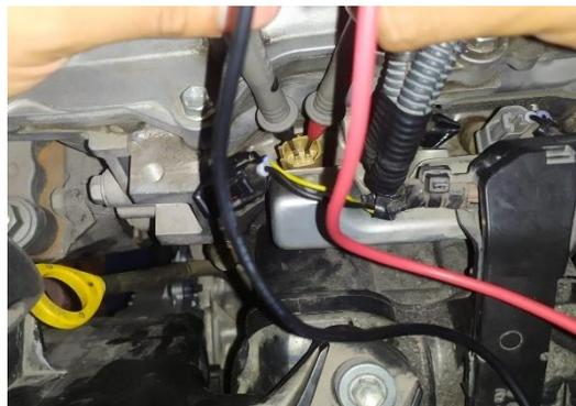
**Figura 2.46** Medición resistencia inyectores
