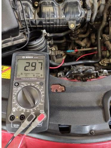
**Figura 2.14** Voltaje de señal del sensor MAP en CONTACTO
