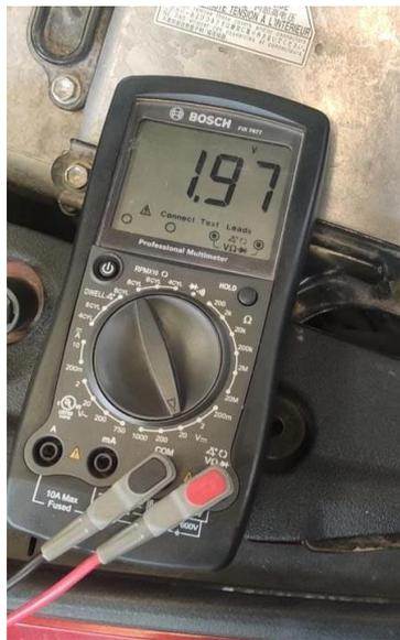
**Figura 3.7** Voltaje máximo del sensor MAP aplicado una carga.
