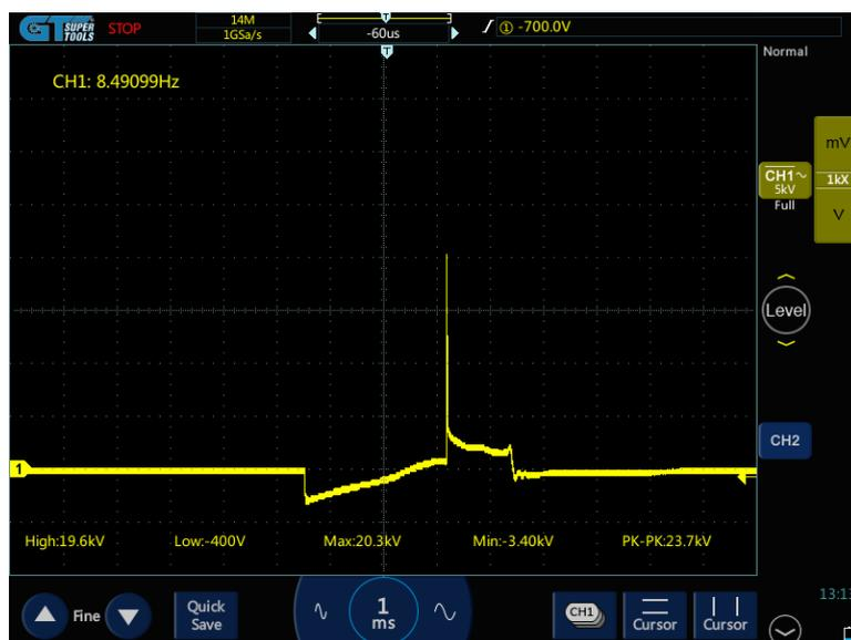
**Figura 3.44** Tiempo de quemado Bobina 4 en ralentí
