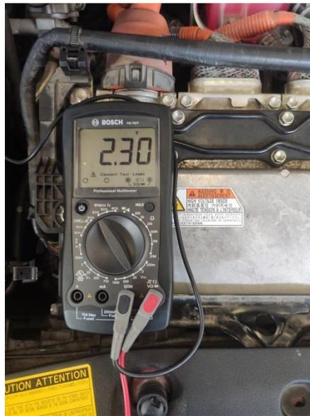
**Figura 2.29** Voltaje de señal del sensor IAT en contacto a 20°C
