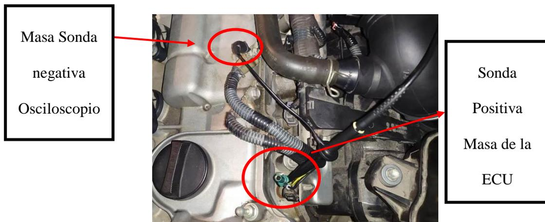
**Figura 2.49** Conexión señal inyector
