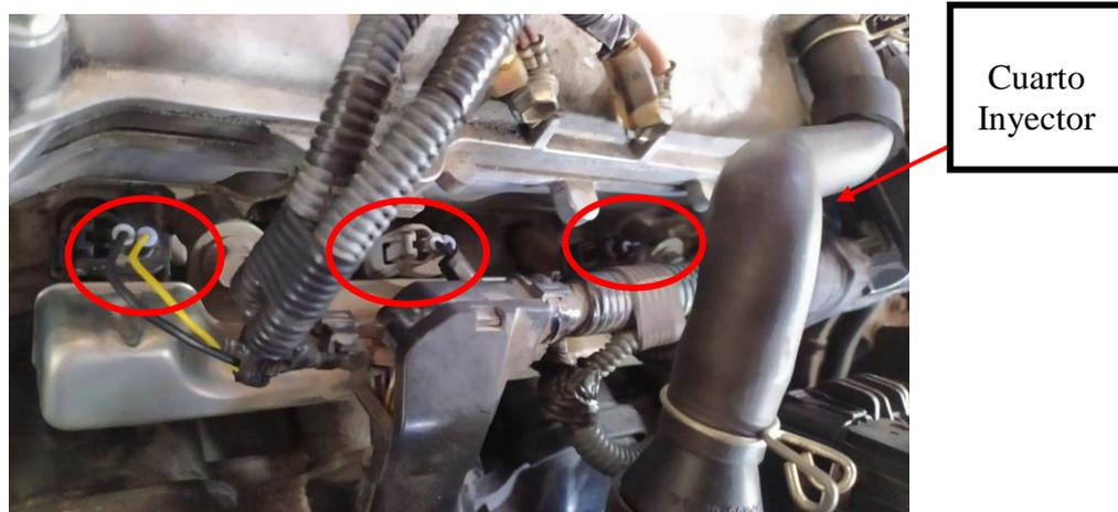
**Figura 2.45** Ubicación inyectores motor 2ZR-FXE
