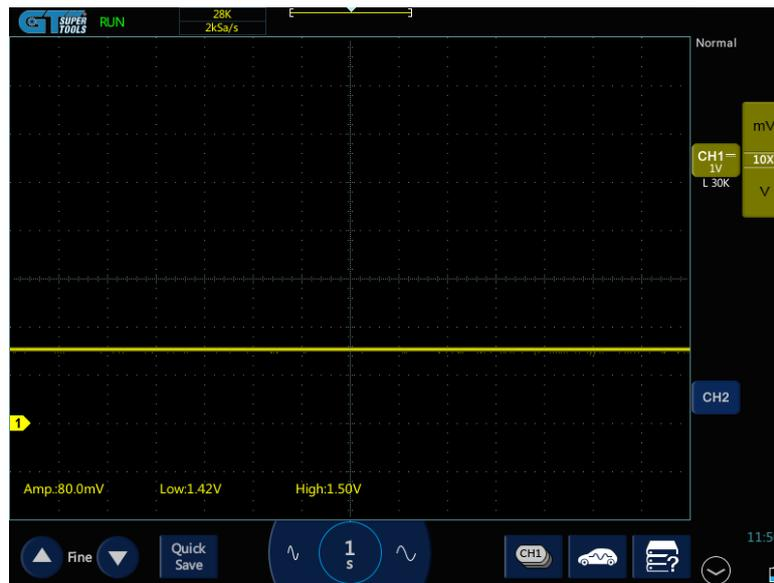
**Figura 2.42** Oscilograma sensor MAF en ralentí
