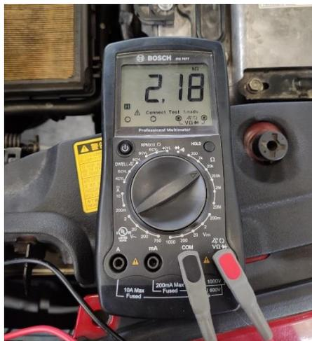
**Figura 2.36** Resistencia del Sensor IAT a 20°C
