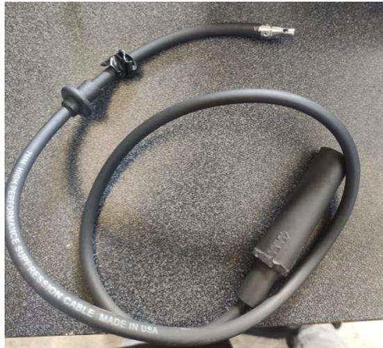
**Figura 2.55** Cables de conexión bobina-bujía
