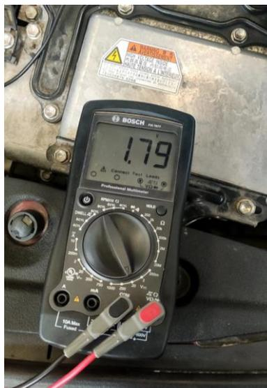
**Figura 2.17** Voltaje mínimo de señal del sensor MAP en ARRANQUE a 20°C
