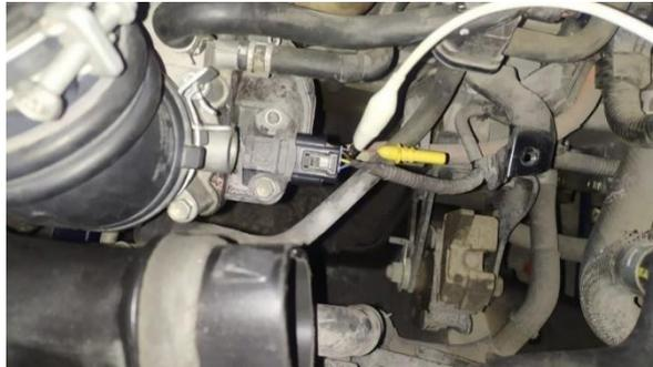
**Figura 2.19** Conexión sonda positiva
