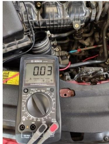
**Figura 2.15** Voltaje de masa del sensor MAP en CONTACTO
