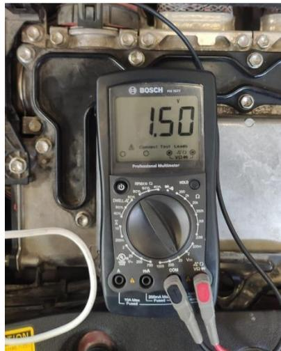
**Figura 2.35** Voltaje de señal en ralentí sensor MAF
