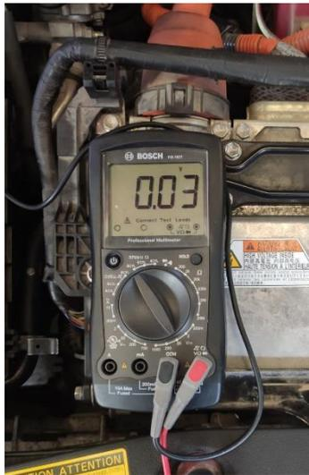
**Figura 2.32** Voltaje de masa del sensor MAF en contacto
