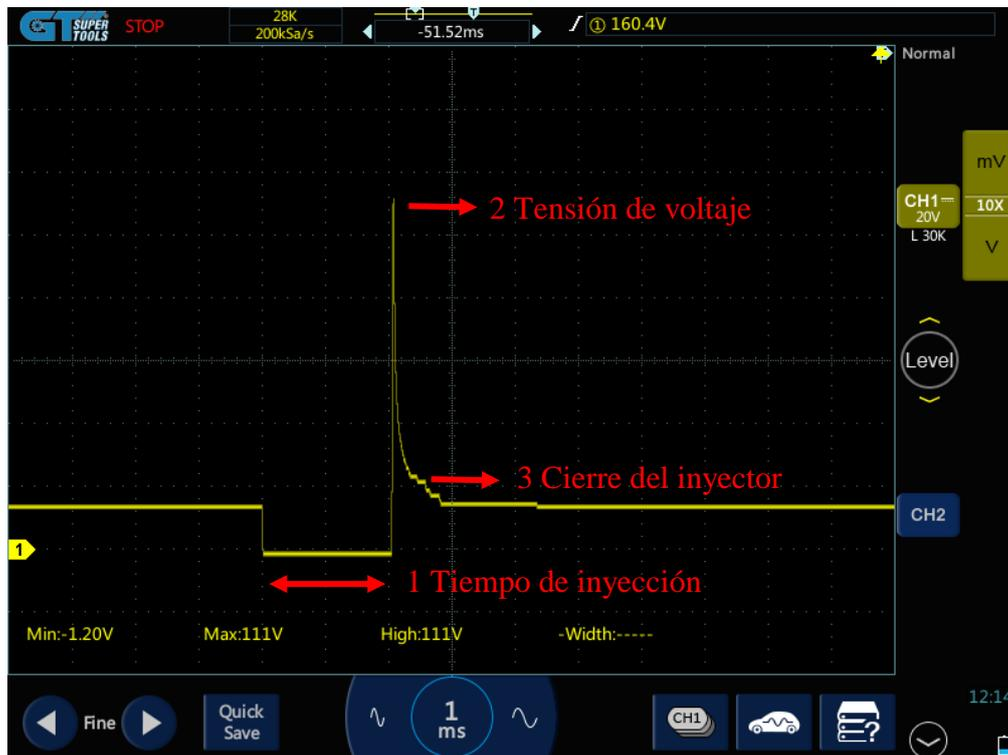
**Figura 3.29** Parámetros de medición del Oscilograma del inyector
