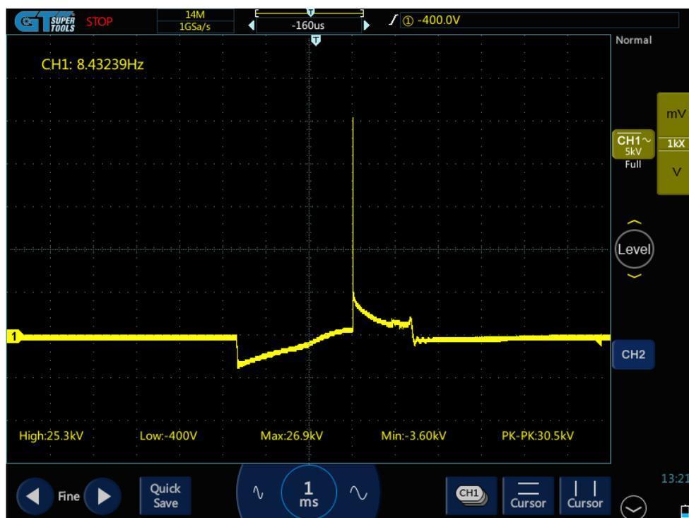
**Figura 3.40** Tiempo de quemado Bobina 2 en ralentí
