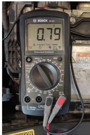
**Figura 2.33** Voltaje de señal del sensor MAF contacto a 20°C
