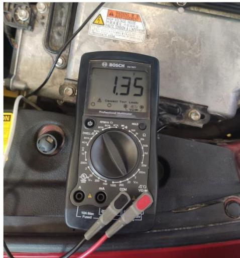
**Figura 2.18** Voltaje de señal del sensor MAP en ralentí a 95°C.
