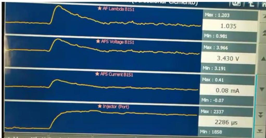
**Figura 3.49** Retroalimentación del Sensor de Oxígeno al desconectar un inyector.
