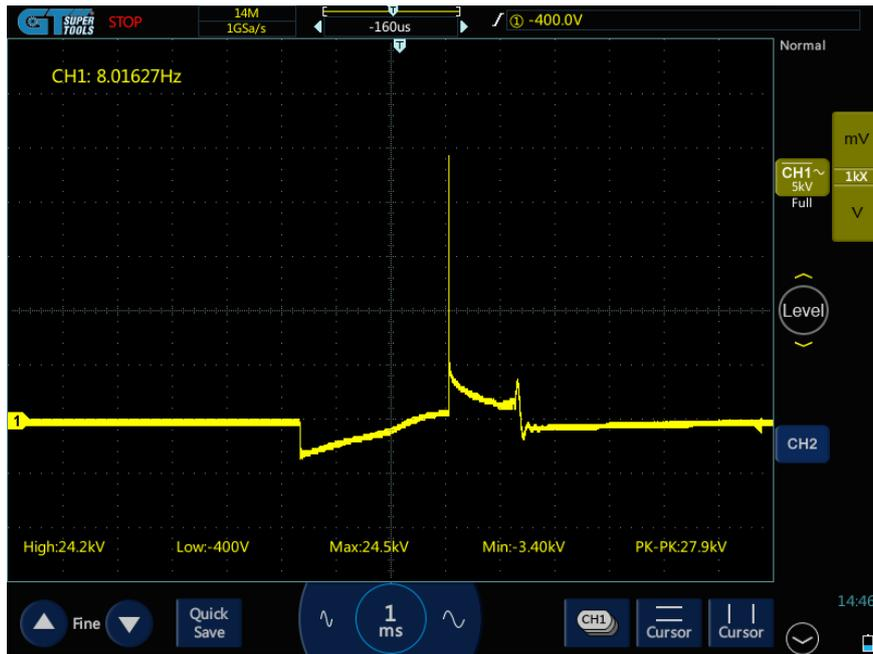
**Figura 3.47** Tiempo de quemado al desconectar un inyector
