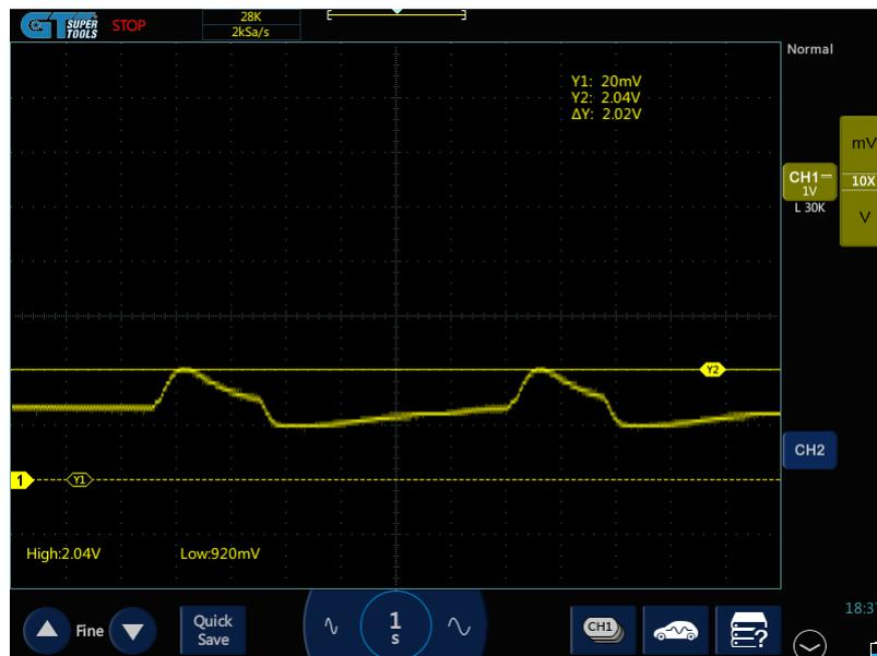
**Figura 3.6** Oscilograma del sensor MAP con aceleración (voltaje máximo)
