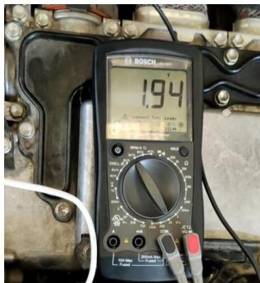
**Figura 2.34** Voltaje máximo en arranque sensor MAF
