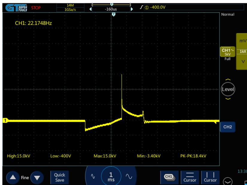
Figura 3.43 Tiempo de quemado Bobina 3 con aceleración
