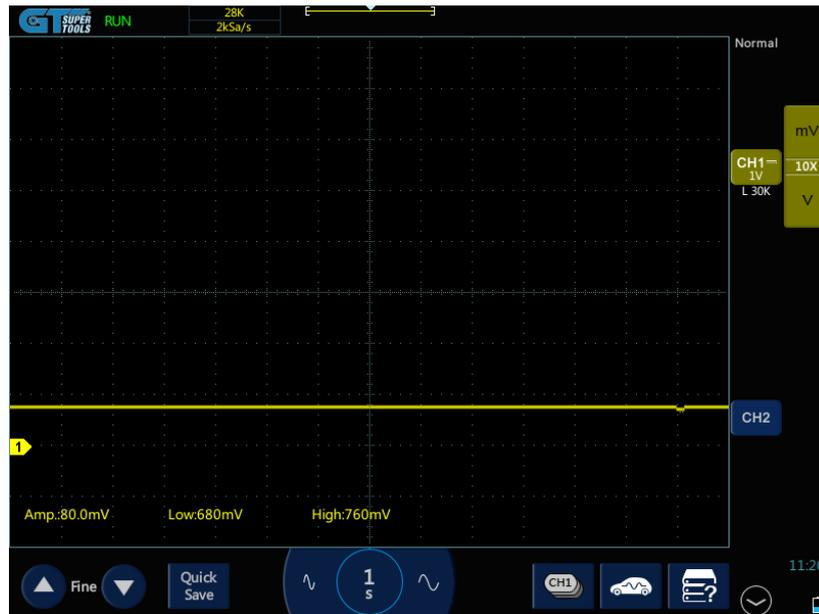
**Figura 2.40** Sensor MAF voltaje de señal en contacto
