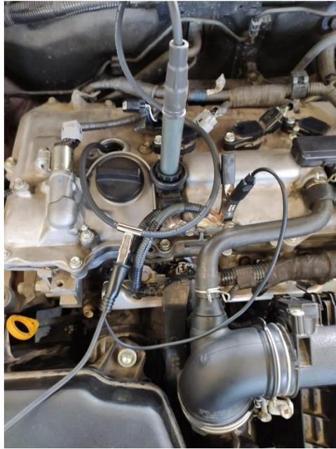
**Figura 2.57** Pinza inductiva para circuito secundario
