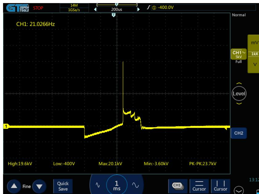
Figura 3.39 Tiempo de quemado bobina 1 con aceleración
