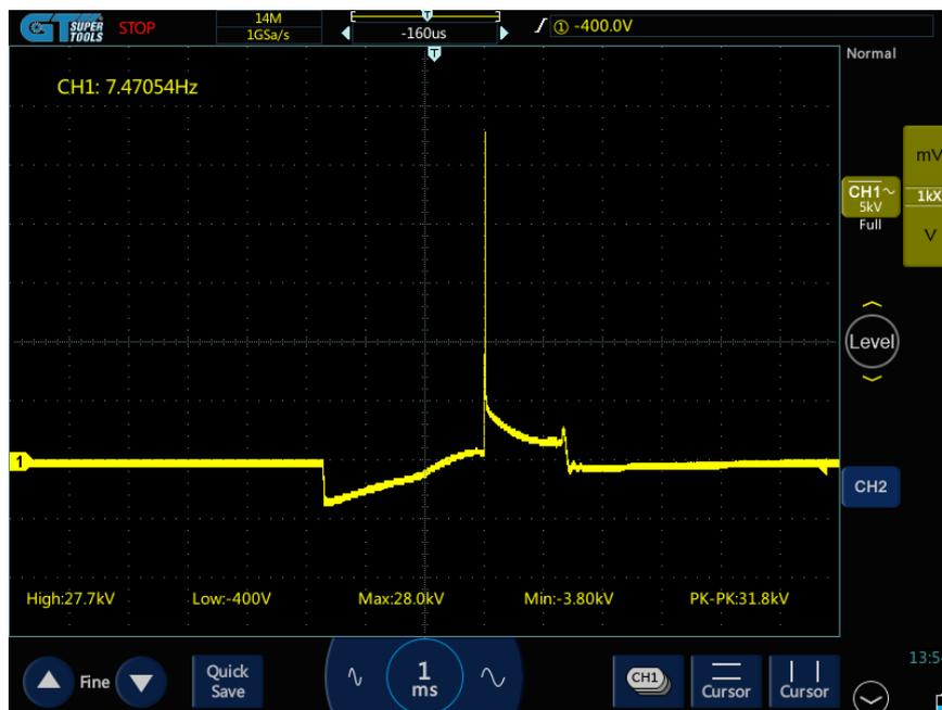
**Figura 3.51** Tiempo de quemado al desconectar una bobina
