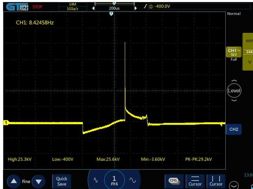
Figura 3.38 Tiempo de quemado Bobina 1 en ralentí
