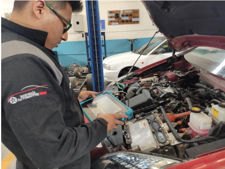
**AI 5:** Toma de valores con el osciloscopio automotriz.
