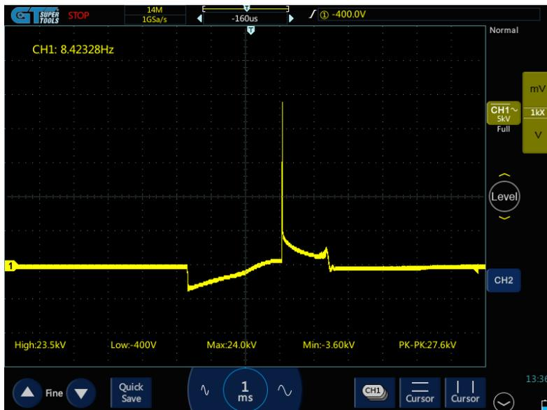
Figura 3.42 Tiempo de quemado Bobina 3 en ralentí
