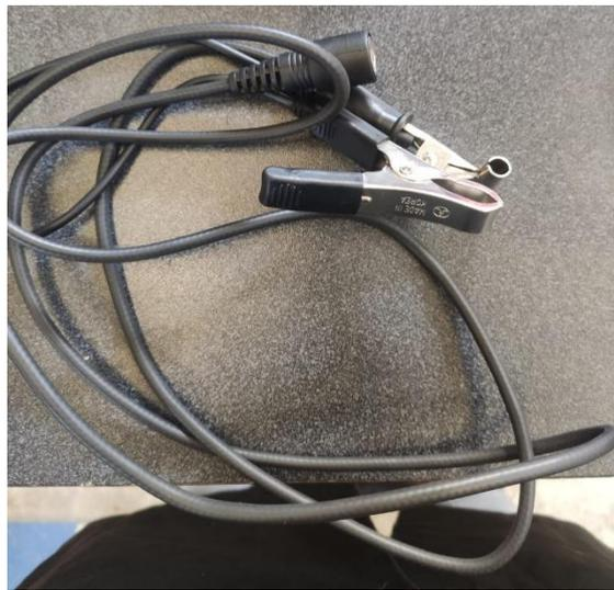
**Figura 2.56** Pinza inductiva para circuito secundario
