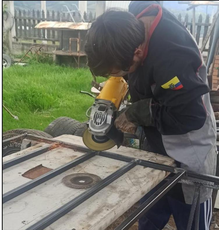
**Fig. 15.** Manufactura de la estructura
