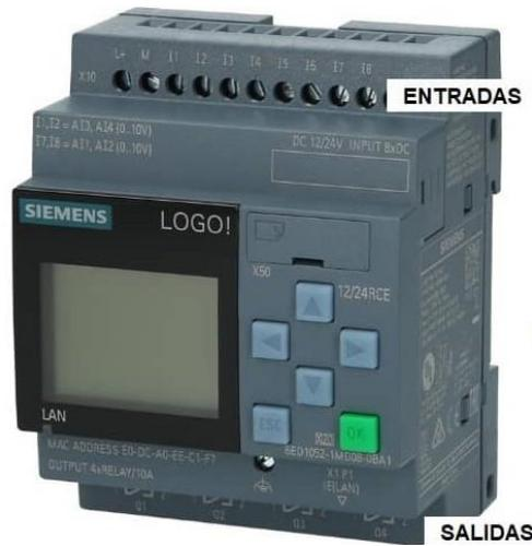
**Fig. 7.** Partes de “PLC LOGO Siemens”. [23]
