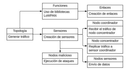
Nota. El diagrama representa el diseño de la red dentro del software de simulación por lo que el bloque principal es la creación de la topología dentro del código para proceder con la creación de los nodos necesarios y la configuración de los enlaces de los mismo para su correcta comunicación.
