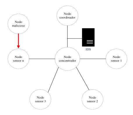
*Nota*. Teniendo en cuenta lo explicado previamente se debe recordar que se realizaba una réplica de tráfico entre nodo concentrador y nodo coordinador, enlace que ahora se usa para la integración del IDS como se observa dentro de la figura. Fuente: Autoría.
