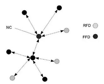
Nota. La ilustración a continuación contiene la estructura de una topología de clúster/árbol en una red WSN. Fuente. Kolev (2014).
