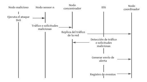
*Nota*. A diferencia de la Figura 14, en esta ya se encuentra en funcionamiento el IDS el cual se encuentra entre el nodo concentrador y nodo coordinador para la detección del tráfico malicioso y generar la alerta. Fuente: Autoría.
