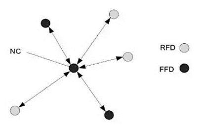
Nota. La imagen contiene la estructura de una topología en estrella en una red WSN. Fuente: Adaptado de Kolev (2014).
