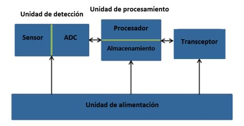
*Nota*. El grafico detallado representa una estructura básica de cómo se encuentra formada un nodo de sensor. Fuente: Adaptado de Ahmed et al (2012).
