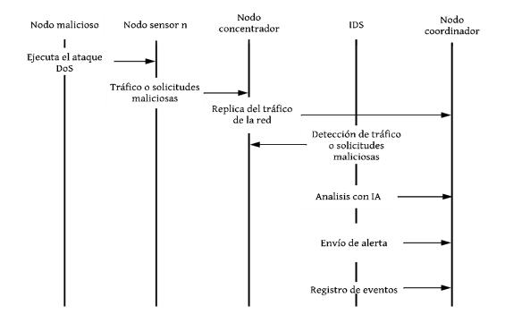
*Nota*. De acuerdo con la figura presentada, es el proceso final de la secuencia de la comunicación del sistema, debido a que, se incluye el funcionamiento del modelo Isolation Forest permitiendo que se generen las alertas tanto del IDS como del modelo implementado. Fuente: Autoría.
