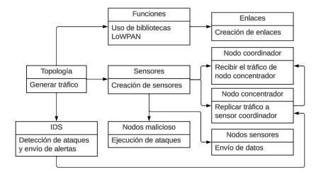
*Nota*. Este diagrama representa la continuación de la Figura 15, en esta figura se puede observar que se agrega el IDS, el cual va a cumplir con sus objetivos de detectar los ataques y el envío de la alerta hacia el nodo concentrador. Fuente: Autoría.
