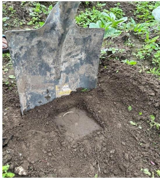
**Fotografía 6.** Método del cilindro para la densidad aparente
