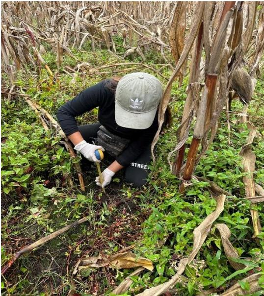
**Fotografía 7.** Medición de la profundidad efectiva del suelo
