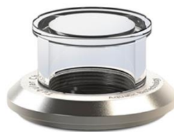
Figura 8. Cámara Utermöhl de 10 ml
