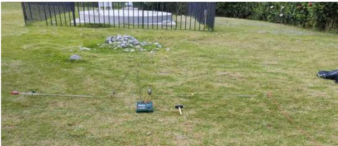
*Nota.* Tal y como se muestra en la Figura 42 la colocación de electrodos sobre el suelo permite la captación de datos específicos en el desarrollo del estudio.
