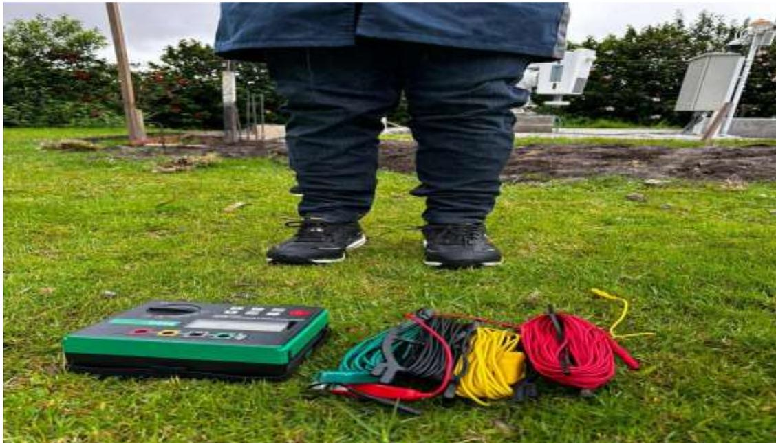
*Nota.* Se observa en la Figura 26 Telurómetro el telurómetro Duoyi-DY4300 que se utilizó para realizar las mediciones, fue el que se escogió porque se adaptó al estudio realizado. Se observa el electrodo en la parte izquierda como este con 4, de igual forma los cables que van conectados al telurómetro para realizar las mediciones.
