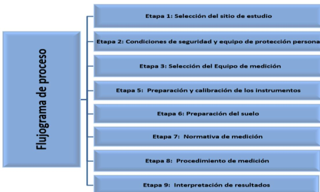
*Nota.* La Figura 34 se visualiza el flujograma de pasos a seguir para el desarrollo del proceso de medición de resistividad del terreno en la Universidad Técnica del Norte.
