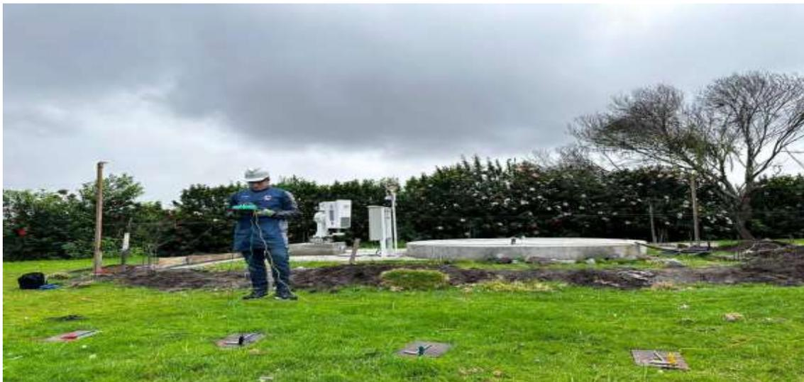
*Nota.* En la Figura 28 se refleja las placas de hierro junto al electrodo de cemento
