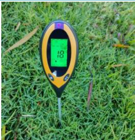
Medidor de PH-temperatura-humedad
