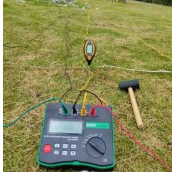
Telurómetro y electrodos
