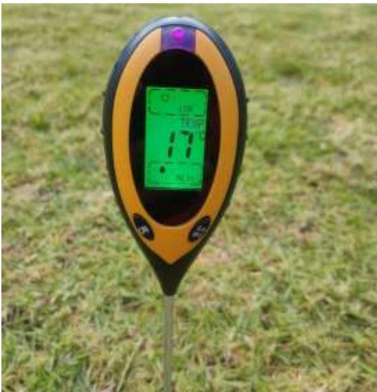
Medidor de PH-temperatura-humedad
