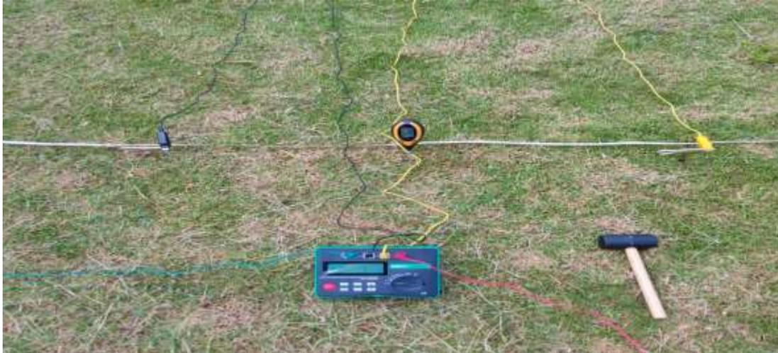
*Nota.* En la Figura 25 se refleja los electrodos de medición insertados directamente al terreno y conectados a un téster eléctrico.
