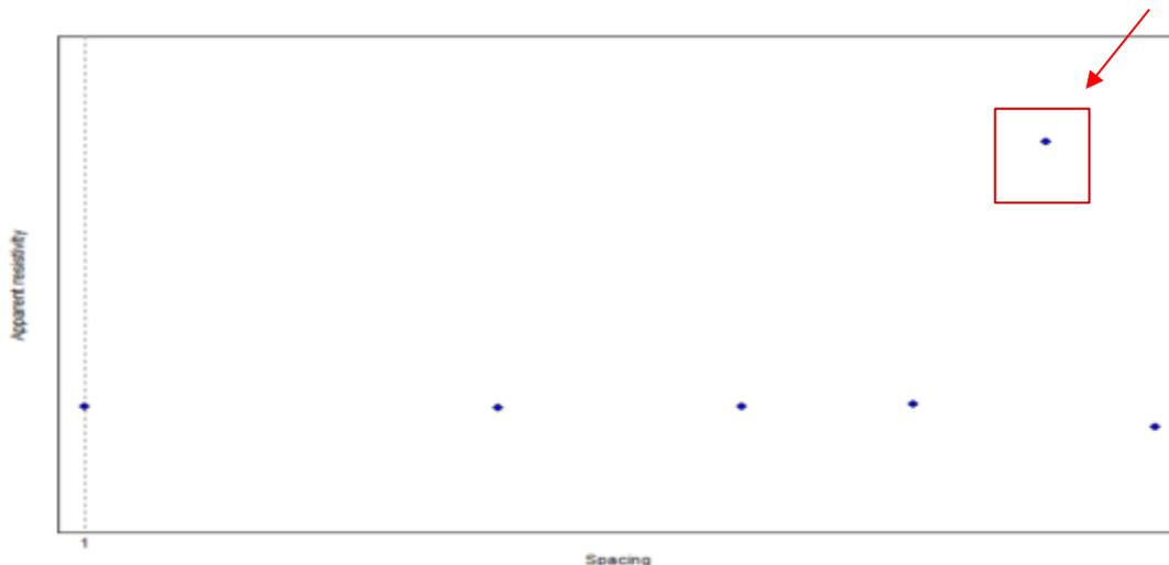
*Nota.* Se observa en la figura 16 los datos fuera de rango, los cuales no se alinean con los datos obtenidos en las otras mediciones.
