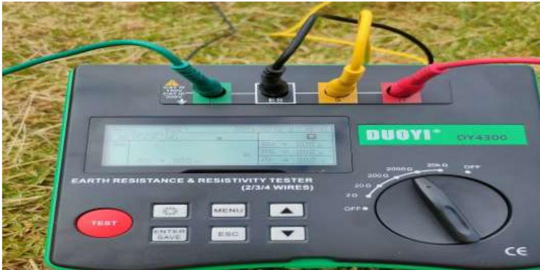
*Nota.* Se refleja en la presente figura el equipo de medición de marca DUOYI, el cual es un téster de medición de resistividad del suelo.
