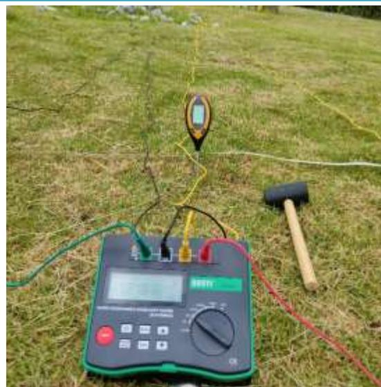
Telurómetro y electrodos
