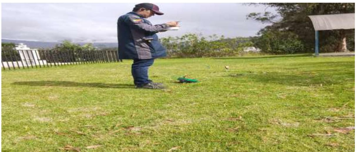
*Nota.* En la figura 43 se refleja el procedimiento de medición de resistividad sobre un determinado sector del terreno con el método empleado necesario para recolección de datos.
