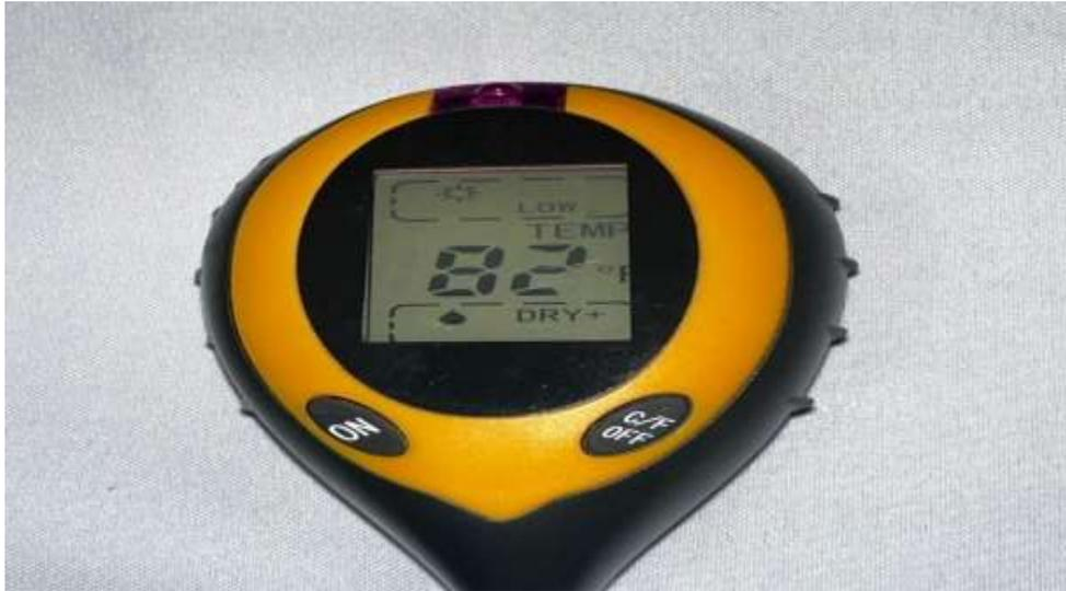
*Nota.* En la **Figura 27** Medidor de PH-temperatura-humedad se puede observar el equipo que se utilizó para realizar el previo estudio de suelo que son necesarias tener en cuenta para el cálculo de la resistividad del terreno.
