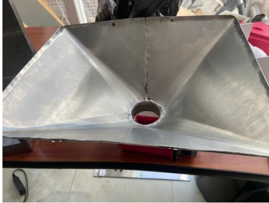
Figura 30 Tolva Manufacturada en acero inoxidable
