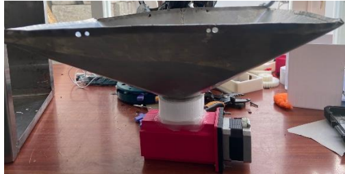
Figura 46 Sistema de distribución con tornillo sin fin
