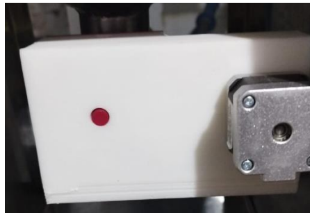
Figura 38 Mecanismo y acople de servomotor
