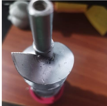
Figura 47 Tornillo sin fin agrietado por el rozamiento generado con el conducto
