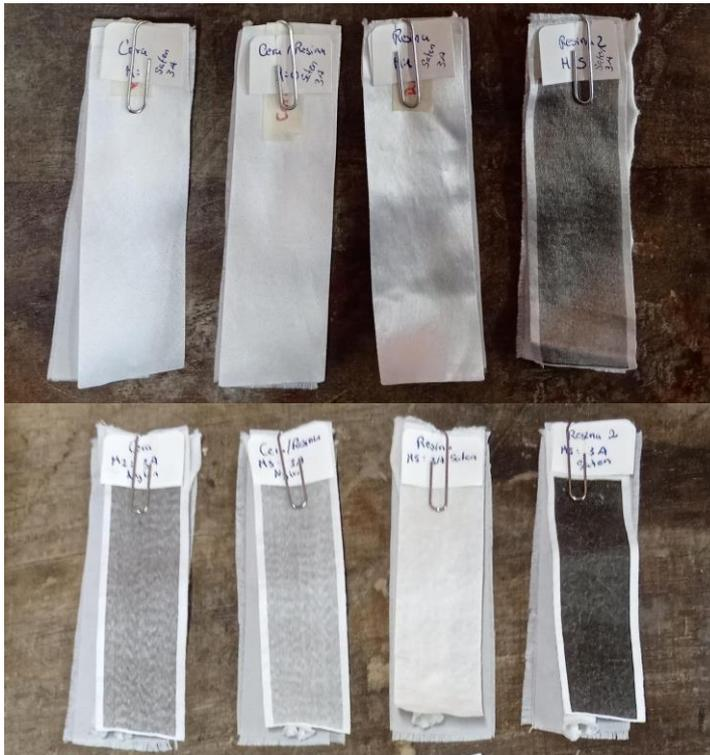
Nota: En la imagen se muestra los resultados del lavado método 3A, en la parte superior etiquetas de satén y en la parte inferior etiquetas de nylon. Fuente: Propia
