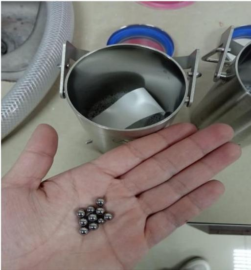
Nota: En la imagen se observa 10 bolas de acero, si bien la norma determina que deben ser bolas de goma, al no tener disponible este material en el laboratorio, se procede a realizar el ensayo con bolas de acero. Fuente: Propia
