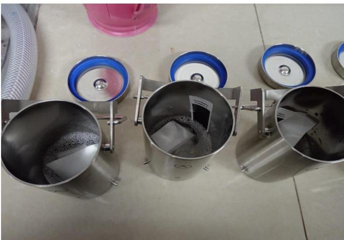
Nota: El frasco de acero inoxidable contiene detergente en polvo y líquido, en un volumen de 150 mL de agua destilada, junto, con la etiqueta a ensayar, testigos de Co y Pes y finalmente 10 bolas de acero. Fuente: Propia
