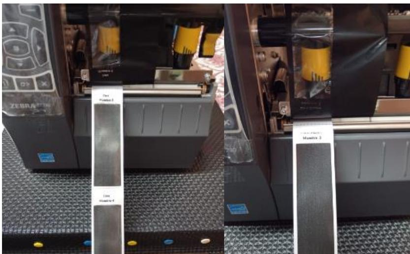
Nota: Una vez diseñadas las etiquetas en el programa Zebra Designer 2 como se observa en la **Figura 8**, se procede a la impresión de seis etiquetas por cada tipo de material “satén/nylon” **Figura 10**, así mismo por cada tipo de ribbon “cera, cera/resina y resinas” **Figura 9**. Fuente: Propia
