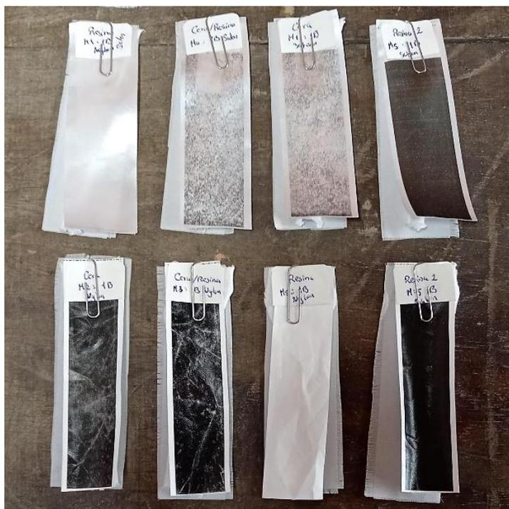
Nota: En la imagen se muestra los resultados del lavado método 1B, en la parte superior etiquetas de satén y en la parte inferior etiquetas de nylon. Figura: Propia
