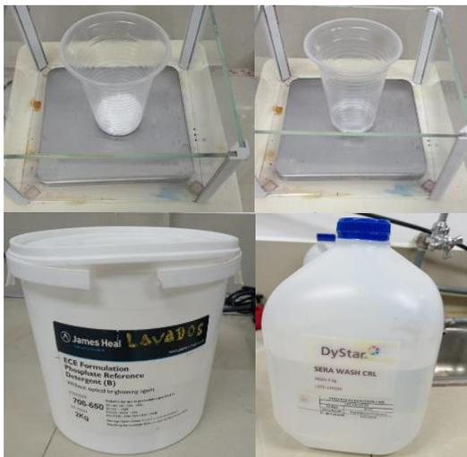
El detergente en el método 3A se debe pesar según lo establecido en la **Tabla 5** en cada probeta a evaluar, en este caso la cantidad pesada de detergente en polvo es 0.075g y líquido 0.115g.
