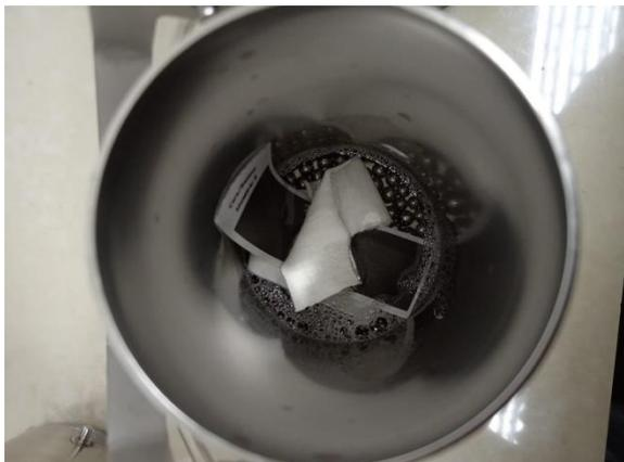
Nota: El frasco de acero inoxidable contiene detergente en polvo y líquido, en un volumen de 50 mL de agua destilada, junto, con la etiqueta a ensayar, testigos de Co y Pes y finalmente 100 bolas de acero. Fuente: Propia
