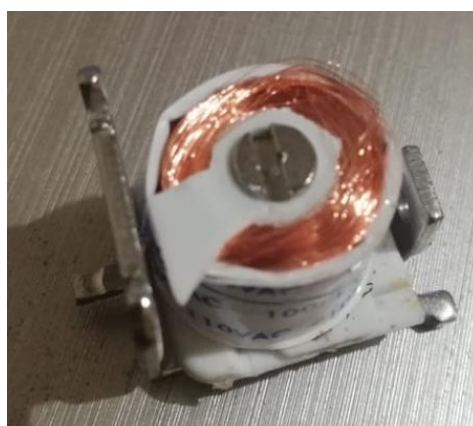
Figura 37. Alambre bobina de hilo de cobre en relé
