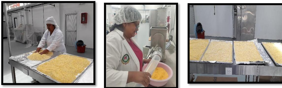
Para ajustar el contenido de humedad de las mezclas 1 y 2 al 9%, éstas se colocaron en un deshidratador a 60°C, con velocidad de aire caliente igual a 3.06 m/s y durante un tiempo de 30 minutos. Tras ese periodo se obtuvieron las mezclas 1 y 2 con un contenido de humedad del 9 %.
