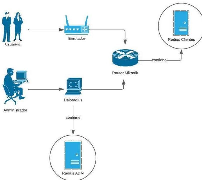
*Nota.* En la imagen se muestra el diagrama de arquitectura que se implementa en el proyecto y sus componentes.
