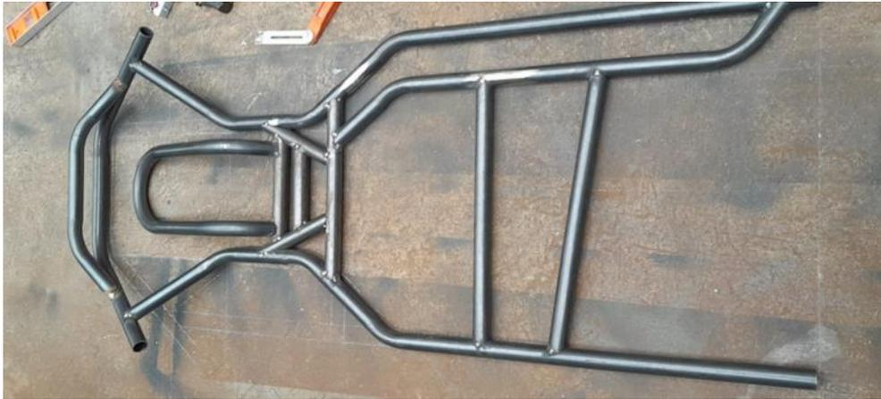
Figura.77 *Fabricación chasis*
