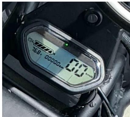
Figura.27 *Velocímetro Digital*
