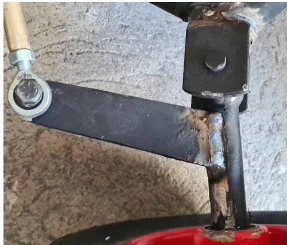
Figura.14 Manguetas de las ruedas del go kart
