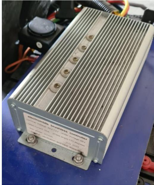
Figura.16 Controlador de Motor BLDC
