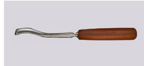
El filo de gubia incide directamente en el rendimiento y la calidad del trabajo, por lo que se debe guardar especial cuidado al afilar la herramienta. El ángulo de corte será de  $17,5^\circ \pm 2,5^\circ$  dependiendo de la dureza de la madera que trabajemos habitualmente.
