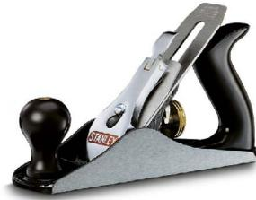
Pueden estar fabricados en madera o metal, en distintos tamaños y pueden ser de desbaste, de testas o de raspado, estos últimos se utilizan para abrir las fibras de la madera para que penetre la cola en las uniones.
