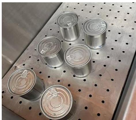
**Sellado:** Posteriormente, las latas fueron selladas herméticamente mediante el uso de una selladora manual como se puede observar en la Figura 17.
