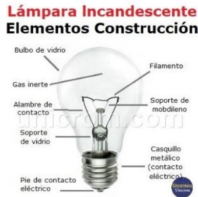
Fig. 1. Partes de una lámpara incandescente
