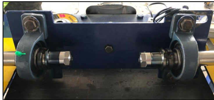
Figura 2.27 Montaje de placa de fuerza
