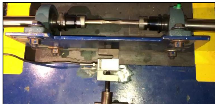
Figura 2.29 Montaje de celda de carga
