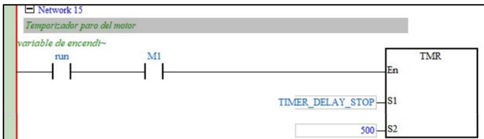
Figura AI.8 Se tiene el temporizador para el paro del motor al momento que la probeta es rota.
