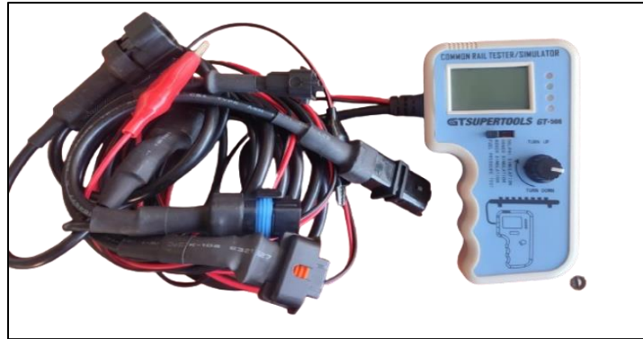
Figura 13 Simulador de presión common rail.
