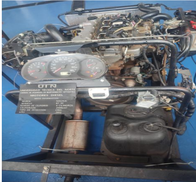
Figura 12 Banco de pruebas motor Mazda BT-50.
