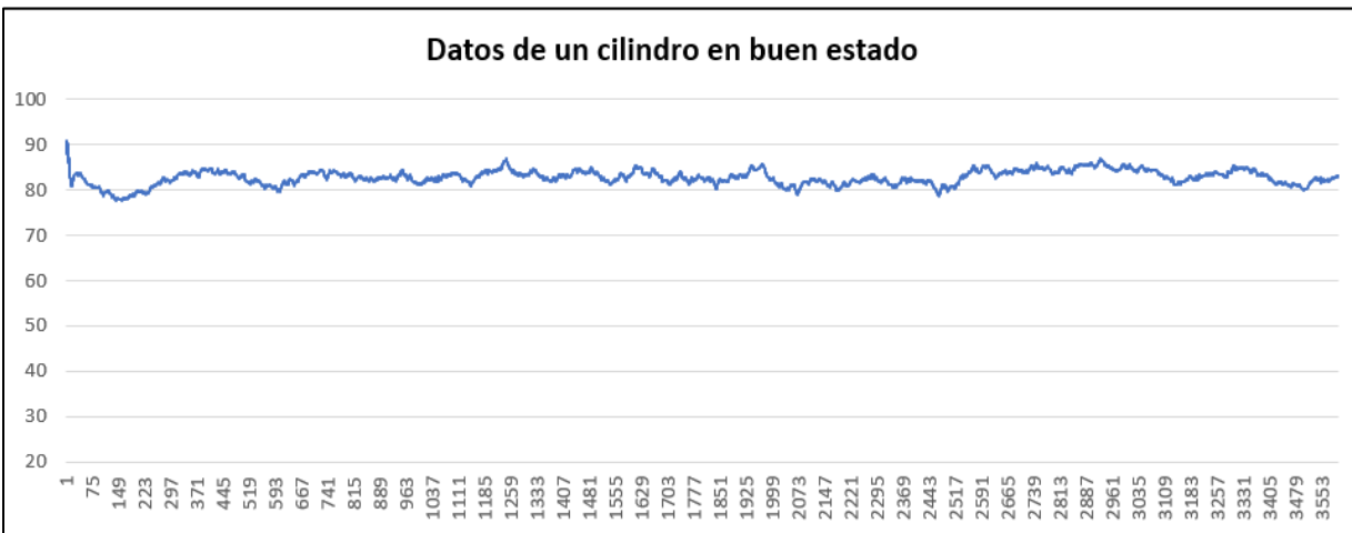
Figura 35 Toma de datos de un cilindro en buen estado.
