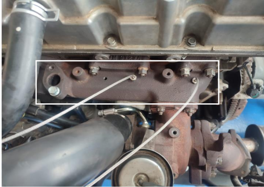
Figura 20 Ubicación y acoplamiento de las termocuplas en el colector de escape en el motor.
