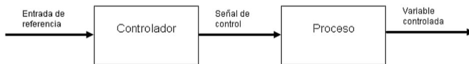
*Figura 2.4: Diagrama de bloque de un sistema en lazo abierto [29].*
