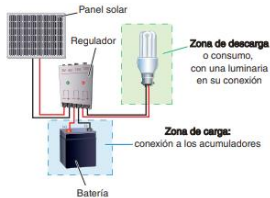
Figura 13. Uso del regulado en un panel solar [20].
