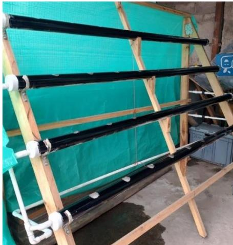
Para el ingreso de nutrientes, se realizaron perforaciones en la parte alta de las tapas con el fin de mantener el flujo del líquido de manera continua y sin riesgo de taponamiento. Para la salida, las tapas se perforan a 35 mm del centro con el fin de asegurar la altura de la lámina nutritiva. Revisar planos en el Anexo D.
