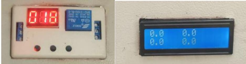
Cuando el temporizador llega a 0 en estado OFF, inicia la cuenta regresiva en estado ON encendiendo la bomba, y la LCD muestra los valores de caudal de cada canal. En la Figura 43 se muestra el temporizador en 3 minutos ON y la LCD imprime los valores de caudal según el flujo de nutrientes.
