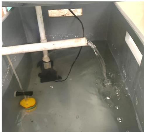
Cuando el nivel de solución nutritiva en el reservorio disminuye hasta los 14 cm, el contactor del flotador se abre impidiendo el flujo de corriente hacia el temporizador y activando la alerta sonora. Como se puede apreciar en la Figura 46, el contactor del flotador impide el paso de corriente hacia el temporizador dejándolo inactivo, mientras que el buzzer de la alerta sonora se encendió emitiendo un sonido con una intensidad de 97,9 decibelios.
