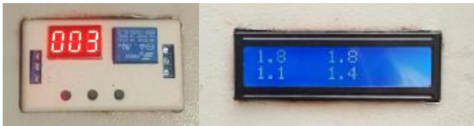
Para aumentar o disminuir el flujo en un canal, se gira la válvula y se observa la variación de caudal en la pantalla LCD. En la Figura 44 se observa la posición inicial de la válvula dando un caudal de 1,8 l/min y al abrirla el caudal cambió a 2,7 l/min.
