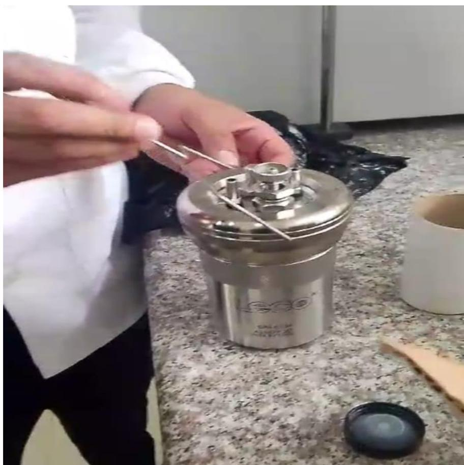
Anexo 16. Colocación de muestras en calorímetro.
