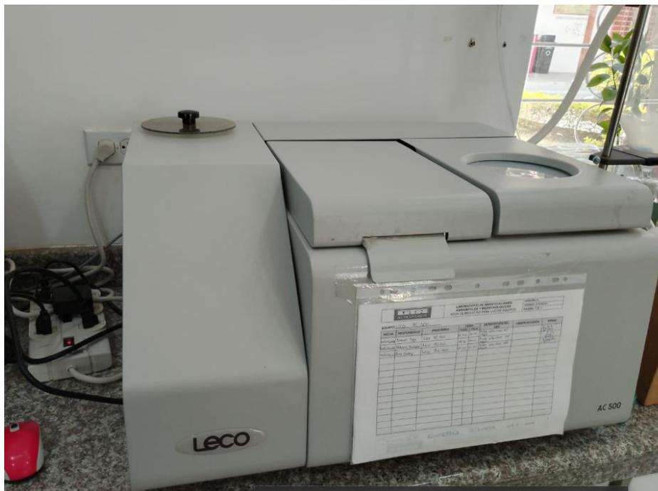
**Figura 11.** Calorímetro leco 500.
