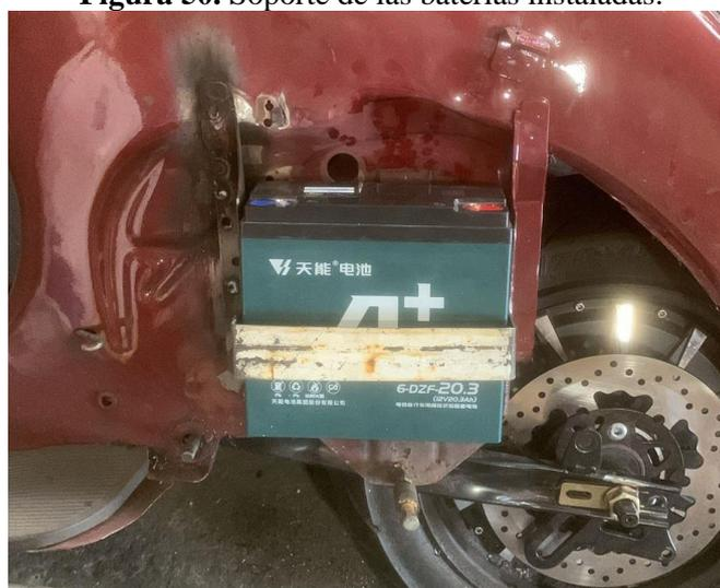
**Nota.** Se muestra el soporte de baterías ya instalado en la motocicleta eléctrica.
