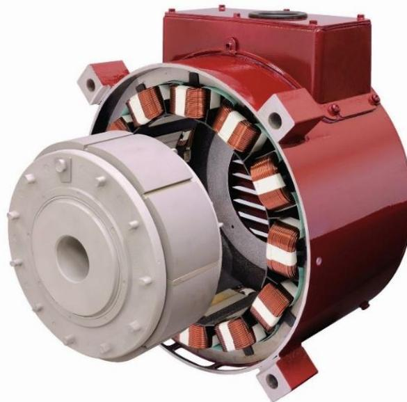
**Nota.** En la figura se observa la estructura del motor Síncrono [31].
