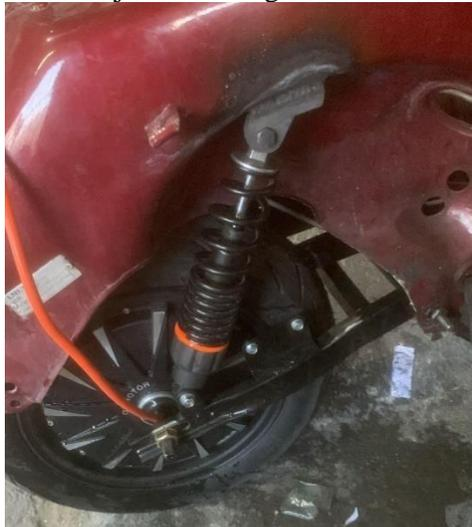
**Nota.** En la figura se observa el amortiguador adaptado a la motocicleta eléctrica.
