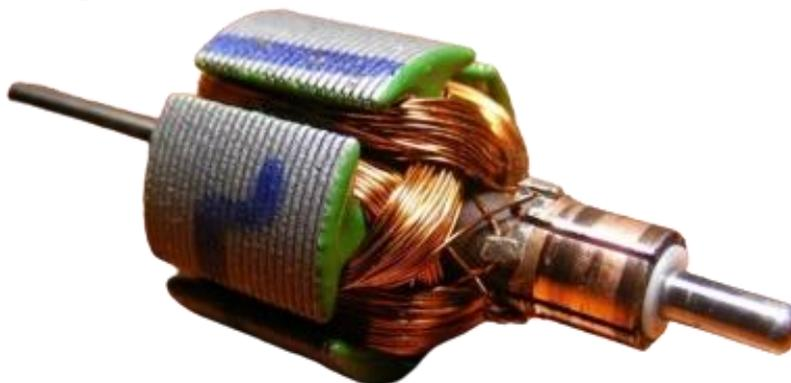
**Nota.** En la figura se observa la estructura del motor con escobillas de imanes permanentes [35].
