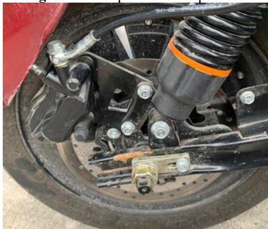
**Nota.** Se muestra el freno posterior que se instaló a la motocicleta eléctrica.
