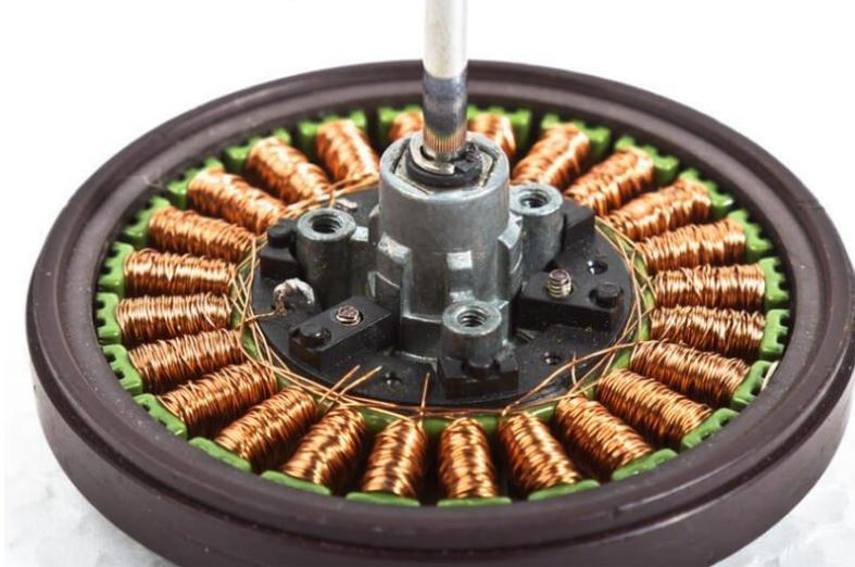
**Nota.** En la figura se muestra el motor brushless y su estructura[38].
