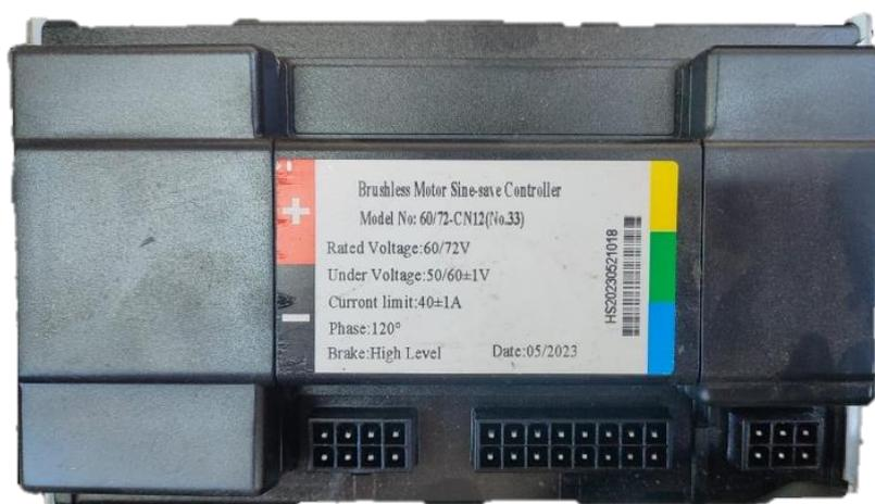
**Nota.** Ilustración del controlador de motor brushless direct current (BLDC) Modelo: 60/72 CN12 (No33) [61].
