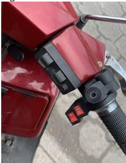
**Nota.** Representación gráfica del acelerador de la motocicleta eléctrica con sus funciones.
