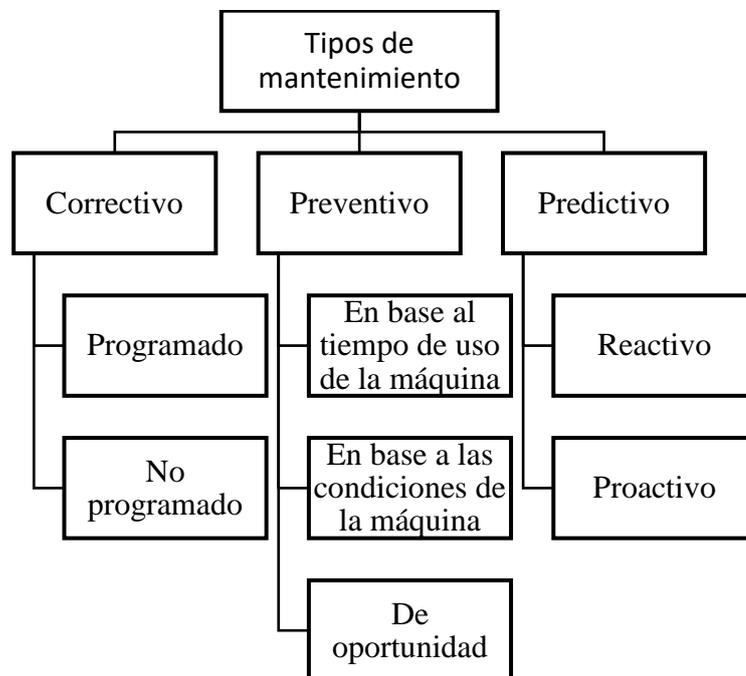
Fig. 1. Tipos de mantenimiento
