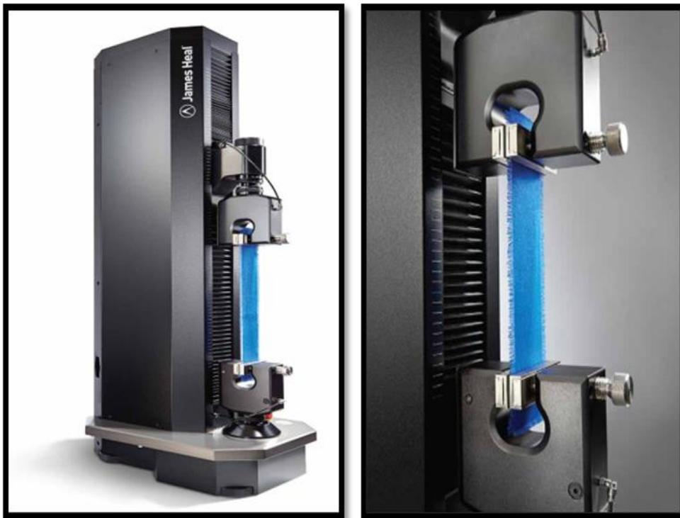
Nota: En la figura se muestra el equipo dinamómetro realizando una prueba de resistencia a la tracción de los tejidos.
