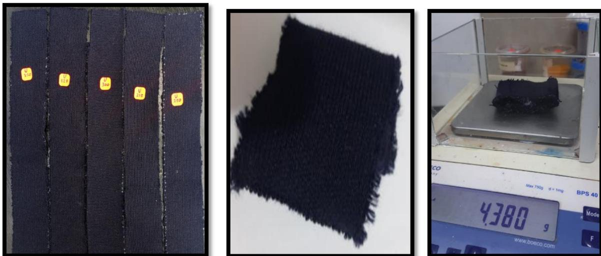
Nota: se muestra el proceso de obtención de la masa por unidad de área en una medida de 10 cm x 10 cm luego del proceso del estirado en el dinamómetro.
