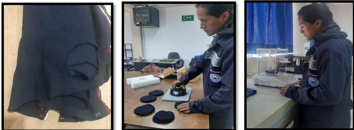
Nota: se muestra la caracterización del tejido con la cortadora circular de 100 cm<sup>2</sup> a partir de la tela, para lo cual se prepararon las muestras de las puntadas 250, 275, 300, 325 y 350
