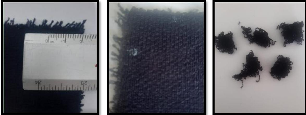
Nota: se muestra la caracterización de las probetas luego de una relajación de 24 horas, en donde se realizó el conteo de los hilos de un centímetro.
