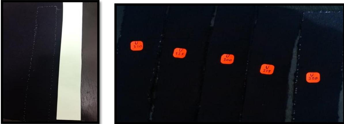
Nota: a partir de tela se realizó la preparación de las muestras con una medida de 40 cm de longitud con un ancho de 5 cm; para las puntadas 250, 275, 300, 325 y 350 se realizó el corte de 2 probetas para la trama y 2 probetas para la urdimbre con un total de 20 muestras.
