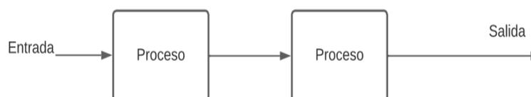
Fig. 7 Sistema de control de lazos abiertos. Adaptado de [21]
