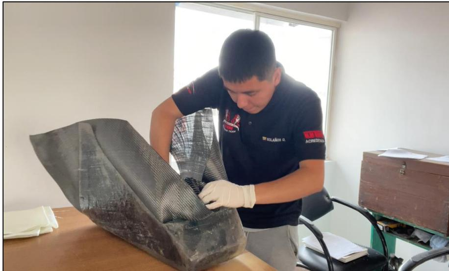
De esta manera, se colocaron más capas de tela de fibra de carbono, reforzando además con una capa de fibra de vidrio. Durante este proceso, se fue dando forma con la resina, asegurando que
