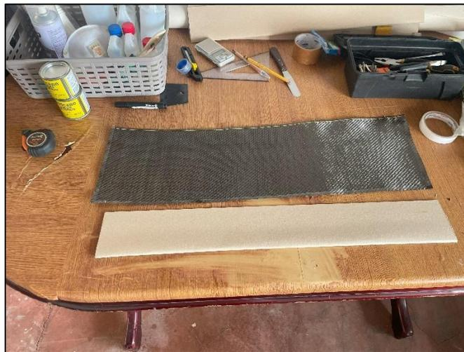
Antes de colocar los refuerzos de fibra de carbono, se cortaron los retazos necesarios para lograr una mayor precisión y reducir el desperdicio de material. Este paso permitió un ajuste más exacto y una aplicación más eficiente de la fibra de carbono en el molde.
