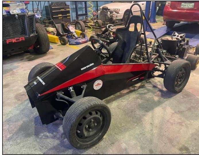
Después de la aplicación del barniz, se procedió al ensamblaje de todas las piezas y a la colocación de los logotipos seleccionados. De esta manera, se logró obtener el resultado final de la carrocería, incluyendo la trompa y el habitáculo del piloto. Este proceso de montaje y personalización no solo completa la apariencia estética del vehículo, sino que también asegura que todas las partes estén correctamente integradas y listas para su uso final.
