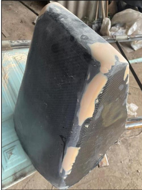
Una vez que se logró una superficie lo más uniforme posible, se procedió a realizar los acabados finales. Estos incluyeron la aplicación de vinil para la personalización de la pieza y la aplicación de barniz automotriz, lo que garantizó un acabado de alta calidad y mayor protección, asegurando que la pieza cumpliera tanto con los requisitos estéticos como funcionales.
