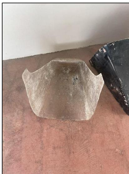
De esta manera, se obtuvo el molde para la sección frontal, el cual se fabricó en dos partes. Esta división facilitó tanto el manejo de los materiales durante la construcción como el proceso de desmoldeo de las piezas finales, permitiendo una mayor precisión y comodidad en ambas etapas.
