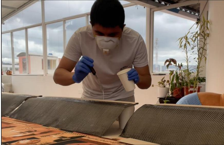
El proceso de aplicación de la resina epóxica en la fibra de carbono fue el mismo que el descrito anteriormente en la construcción de la nariz. Una vez que se obtuvieron todas las partes del alerón, se procedió a unirlos.
