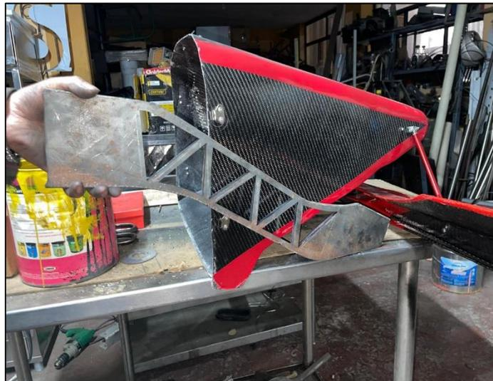
De esta manera, se procedió a ensamblar los brazos estructurales en el chasis del vehículo. El proceso incluyó la fijación precisa de los brazos para garantizar que estuvieran firmemente sujetos y alineados correctamente.
