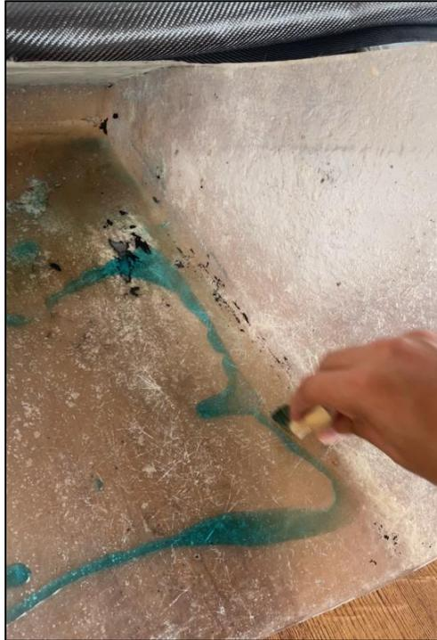
Una vez que el desmoldante se secó por completo, se procedió a preparar la mezcla de resina epóxica con su catalizador en una proporción de 10:2. Esta relación fue cuidadosamente medida en gramos para asegurar la precisión del proceso. La mezcla se agitó durante 5 minutos, asegurando una correcta homogeneización de los componentes, lo cual fue fundamental para obtener una reacción química uniforme y óptima en el curado de la resina.
