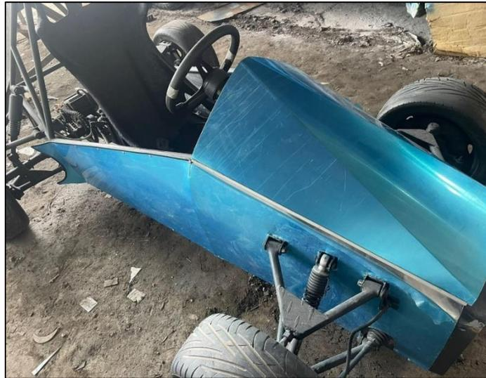
La parte de la carrocería hecha de aluminio se instaló para mejorar y aumentar la durabilidad del vehículo y su rendimiento. Además de mejorar la resistencia a la corrosión, el aluminio redujo el peso del automóvil. Al instalar esta parte de la carrocería con atención y precisión, se garantizó que el automóvil se viera y funcionara según lo esperado. Como resultado, el vehículo en el que se instaló la parte se consideró más seguro y eficiente.
