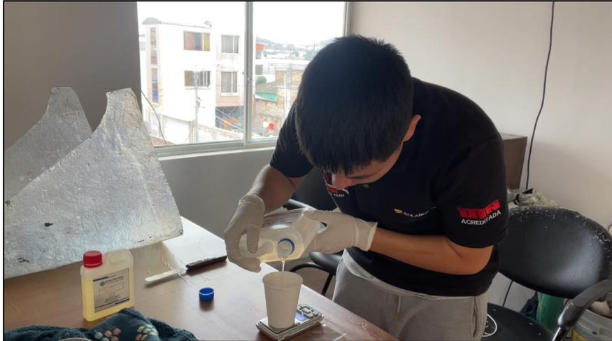
Se aplicó una capa fina de la mezcla y se esperó a que se secase. Una vez seca al tacto, aproximadamente en 40 minutos, se colocó el retazo de fibra de carbono cubriendo por completo el molde. Se aseguró que toda la tela hiciera contacto con la superficie, prestando especial atención a los bordes, donde resultaba más difícil que la tela se ajustara correctamente.
