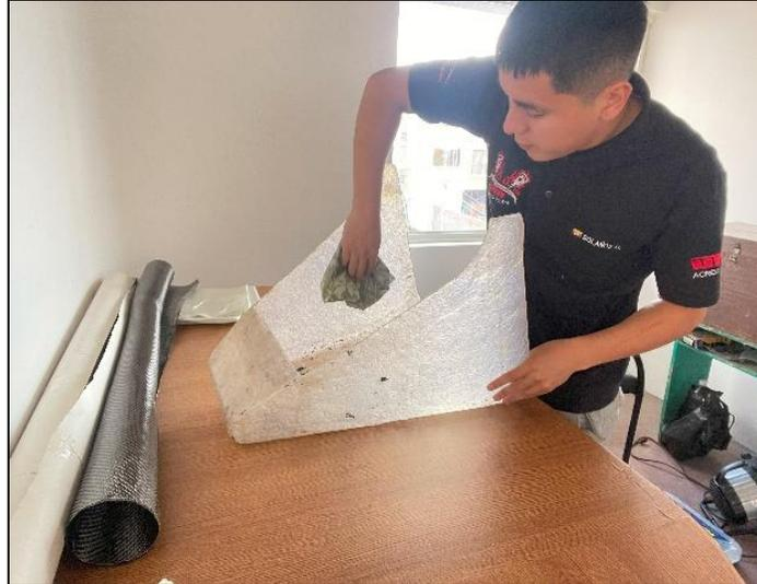
Una vez que el molde estaba debidamente preparado, se procedió a cortar la tela de fibra de carbono de manera que cubra completamente la superficie del molde. Es fundamental dejar algunos excesos de material que sobresalgan del molde, ya que esto aseguró un ajuste adecuado y evita posibles fallos o faltantes en los bordes durante el proceso de laminado.
