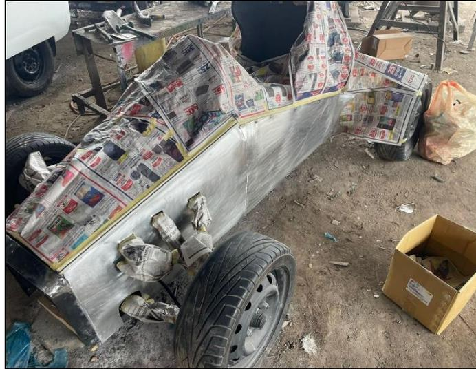
En la Figura se observa el vehículo después de haber sido empapelado y lijado, preparándolo para la aplicación de la imprimación y las capas de pintura necesarias para asegurar un acabado uniforme y duradero.
