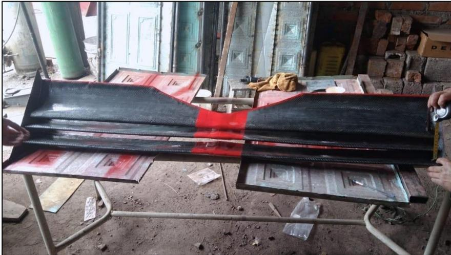
Como paso final, se llevó a cabo la corrección de imperfecciones del alerón. Para ello, se lijo cuidadosamente la superficie para eliminar cualquier defecto visible y se aplicó una capa de barniz para proporcionar una cobertura uniforme y un acabado brillante.
