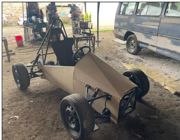
Este fue el aspecto del vehículo con la carrocería montada, que se modeló utilizando láminas de cartón como referencia. Este proceso no solo garantizó la estructura inicial del vehículo, sino que también sirvió de guía visual para los futuros pasos de producción y montaje.
