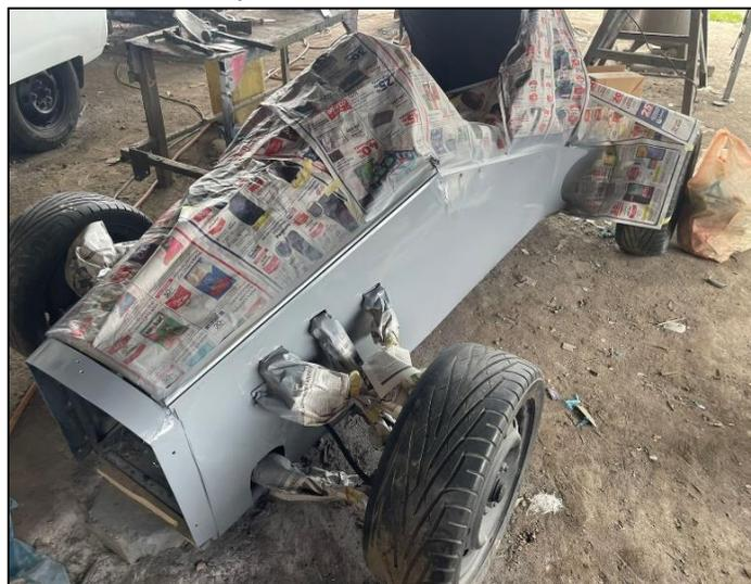
Se preparó la pintura de fondo y se aplicó con una relación de 2 partes de pintura por 1 parte de thinner, garantizando así un acabado óptimo. Este fondo se aplicó directamente a las piezas utilizando una pistola de pintura automotriz, asegurándose de cubrir completamente todas las superficies y mantenerlas libres de impurezas que podrían afectar la calidad del acabado final. Fue fundamental este proceso para evitar cualquier mal acabado en la apariencia final del vehículo.
