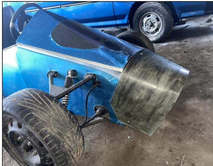
Una vez definidos los puntos de ensamblaje, se procedió a dar forma a la parte frontal, con el objetivo de que se ajuste lo más fielmente posible al diseño original. Así, mediante la unión de
