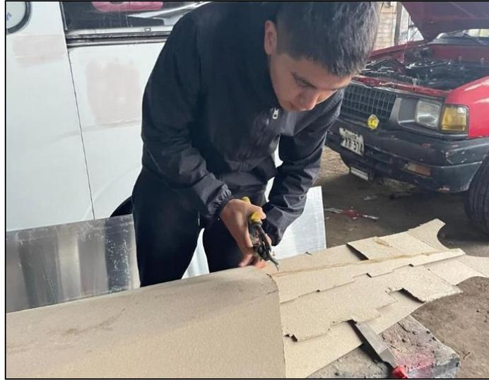
Este enfoque divide la carrocería en secciones, lo que facilita enormemente el montaje posterior. Esta estrategia no sólo simplificó el proceso de montaje, sino que también permitió una mayor precisión en la alineación y el ajuste de cada pieza. Además, la división de la carrocería en secciones optimiza el transporte y almacenamiento de las piezas, contribuyendo a una logística más eficiente en el proceso de manufactura y montaje del vehículo.
