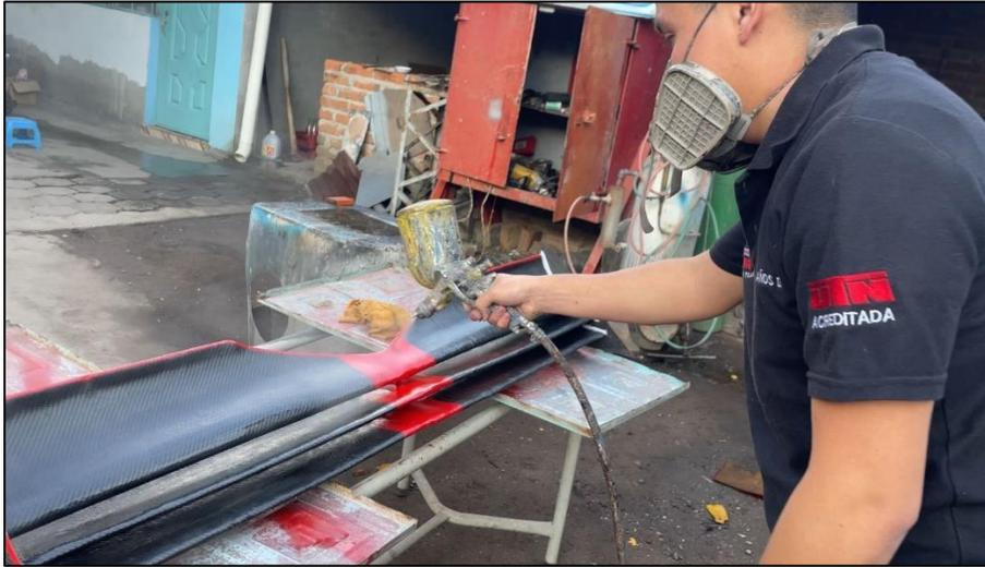
De este modo, el alerón quedó completamente preparado para el ensamblaje final. Con la corrección de imperfecciones y la aplicación del barniz completadas, el alerón presentó una superficie lisa y uniforme, lista para integrarse al vehículo.
