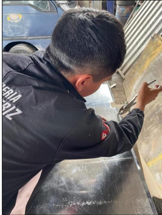
La siguiente etapa consistió en doblar los bordes de las láminas de aluminio para lograr que la pieza adopte la forma deseada de la estructura. Se emplearon métodos de plegado precisos para moldear las piezas de aluminio, asegurando una transición fluida entre las diversas partes del cuerpo del vehículo. Además de mejorar el aspecto visual del vehículo, este proceso también favorece su aerodinámica y resistencia en general.
