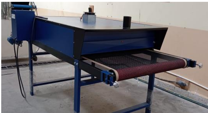
Túnel de secado de la Planta Académica Textil
