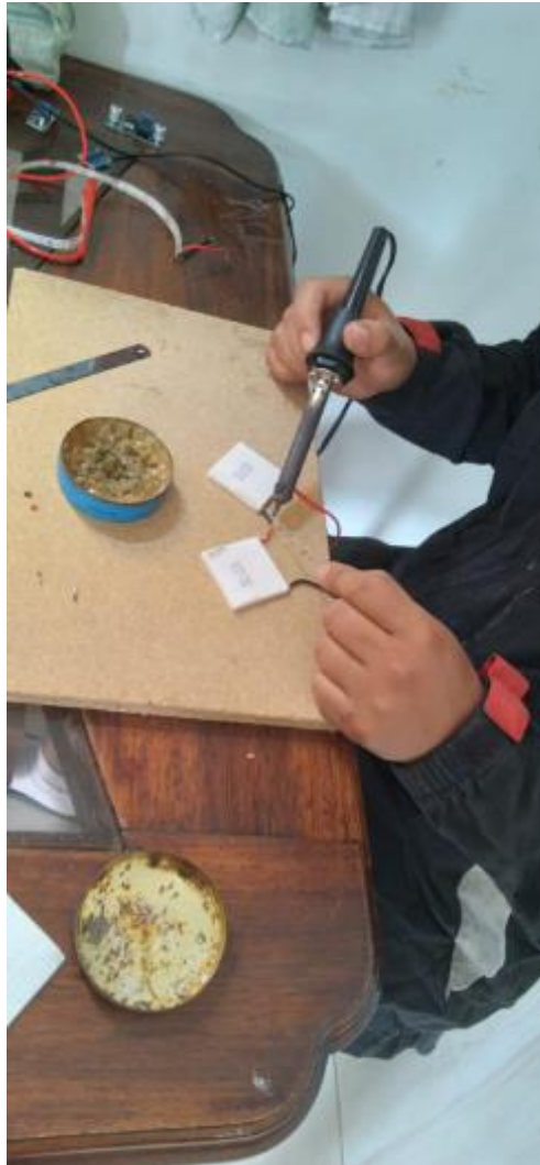
Soldadura en serie de las celdas Peltier
