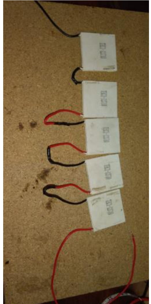
Circuito de 5 celdas Peltier en sri
