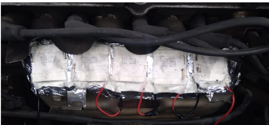
Circuito con aislamiento térmico montado sobre el colector de escape del vehículo
