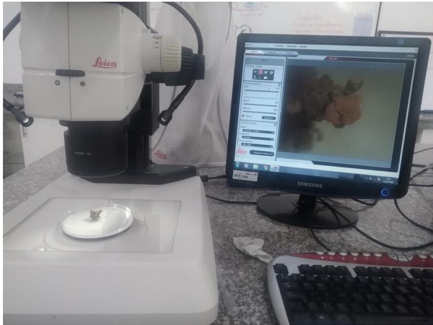
**Figura 65.** Estereomicroscopio con cámara incluida que permite a través del software visualizar en la pantalla del ordenador
