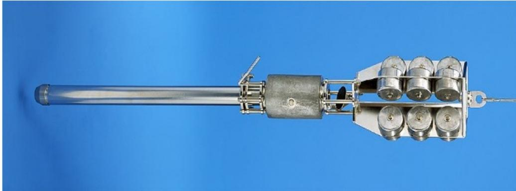
Figura 77. Corer de gravedad
