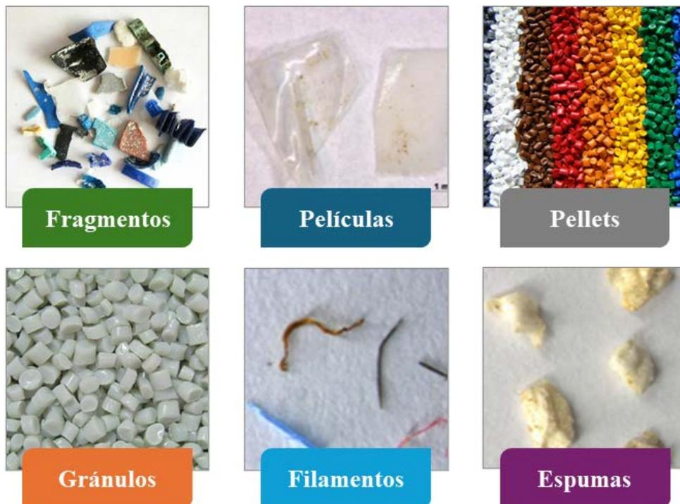
Figura 33. Formas de los microplásticos
