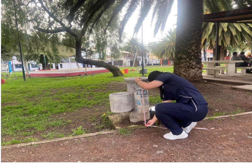
Figura 5. Toma de altura de bebedero en base a las señaléticas de accesibilidad.
