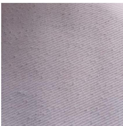
Nota: La muestra 0 al igual que las tres probetas tratadas tienen un resultado de grado de pilling 1, definiéndose como muy severo.
