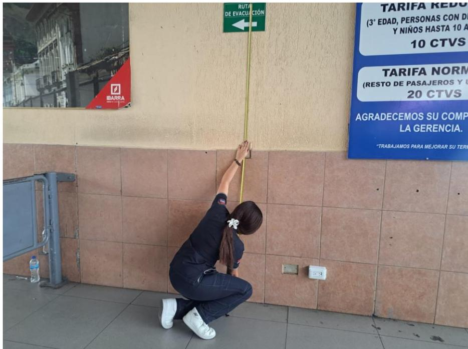
**Figura 1.** *Medición de la altura de una señalización visual.*
