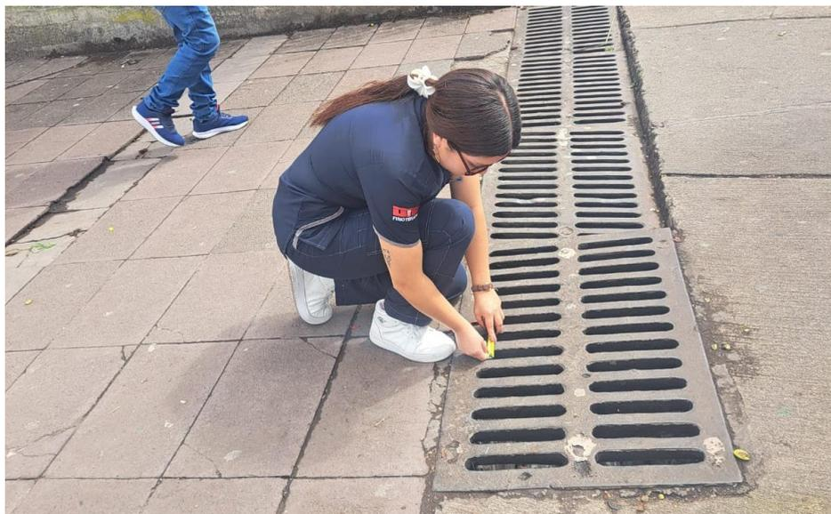
**Figura 3.** *Medición de la separación de orificios de la rejilla.*
