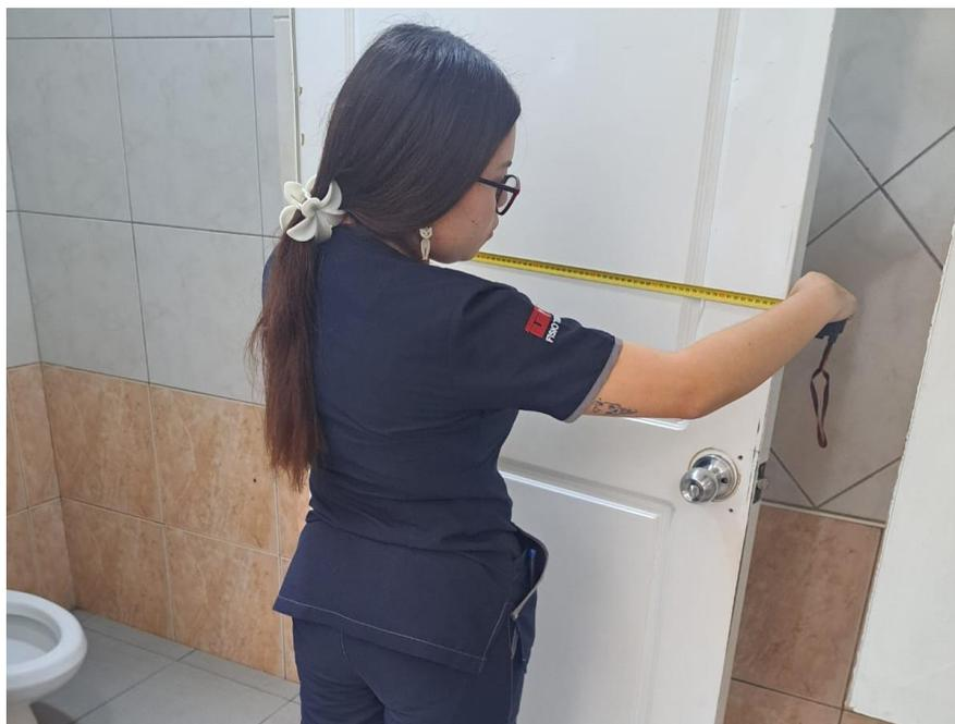
**Figura 8.** *Medición del ancho de la puerta del baño exclusivo para personas con discapacidad.*
