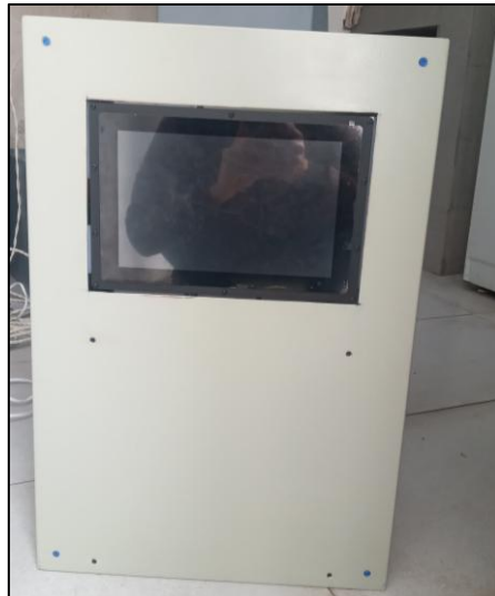
Fig. 4.90 Pantalla instalada en envolverte.
