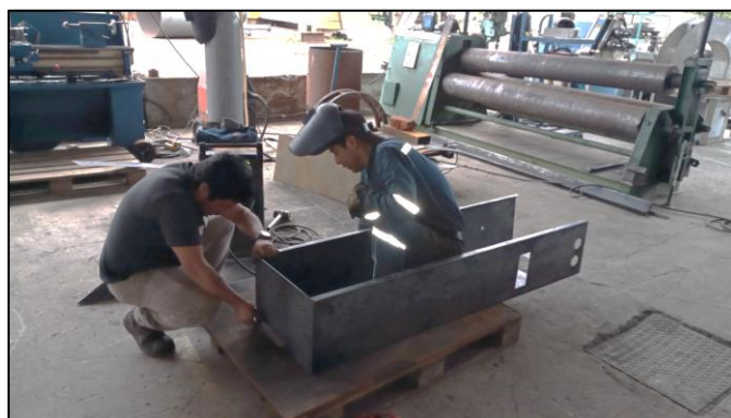
Fig. 4.81 Proceso de soldadura de subensamble “Estructura”.
