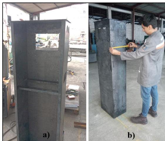
Fig. 4.82 Construcción del subensamble “estructura”. a) Vista trasera, b) Verificación de dimensiones.
