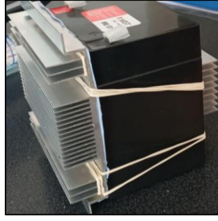
Fig. 4.8 Batería de 12 V y 5 Ah recargable VRLA con disipadores.
