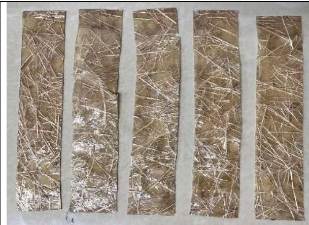
Muestra de 70% de resina acrílica y 5 cm de longitud de fibra
