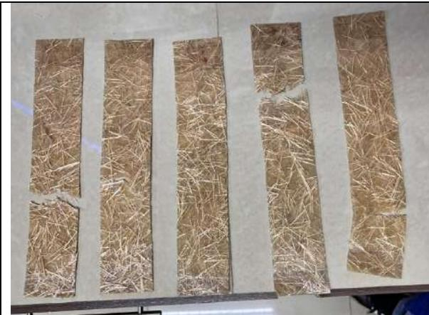
Muestra de 70% de resina acrílica y 2 cm de longitud de fibra
