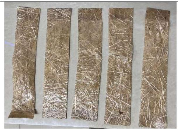
Muestra de 80% de resina acrílica y 5 cm de longitud de fibra
