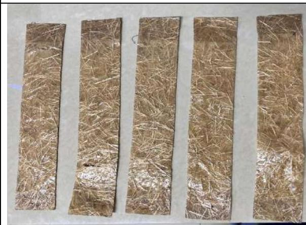
Muestra de 80% de resina acrílica y 2 cm de longitud de fibra
