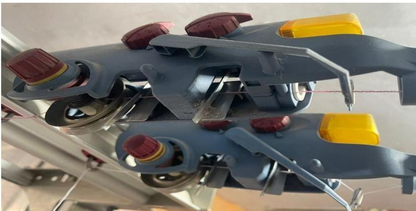
Nota: La imagen muestra los tensores de una máquina rectilínea y cómo funcionan. Fuente: Propia.
