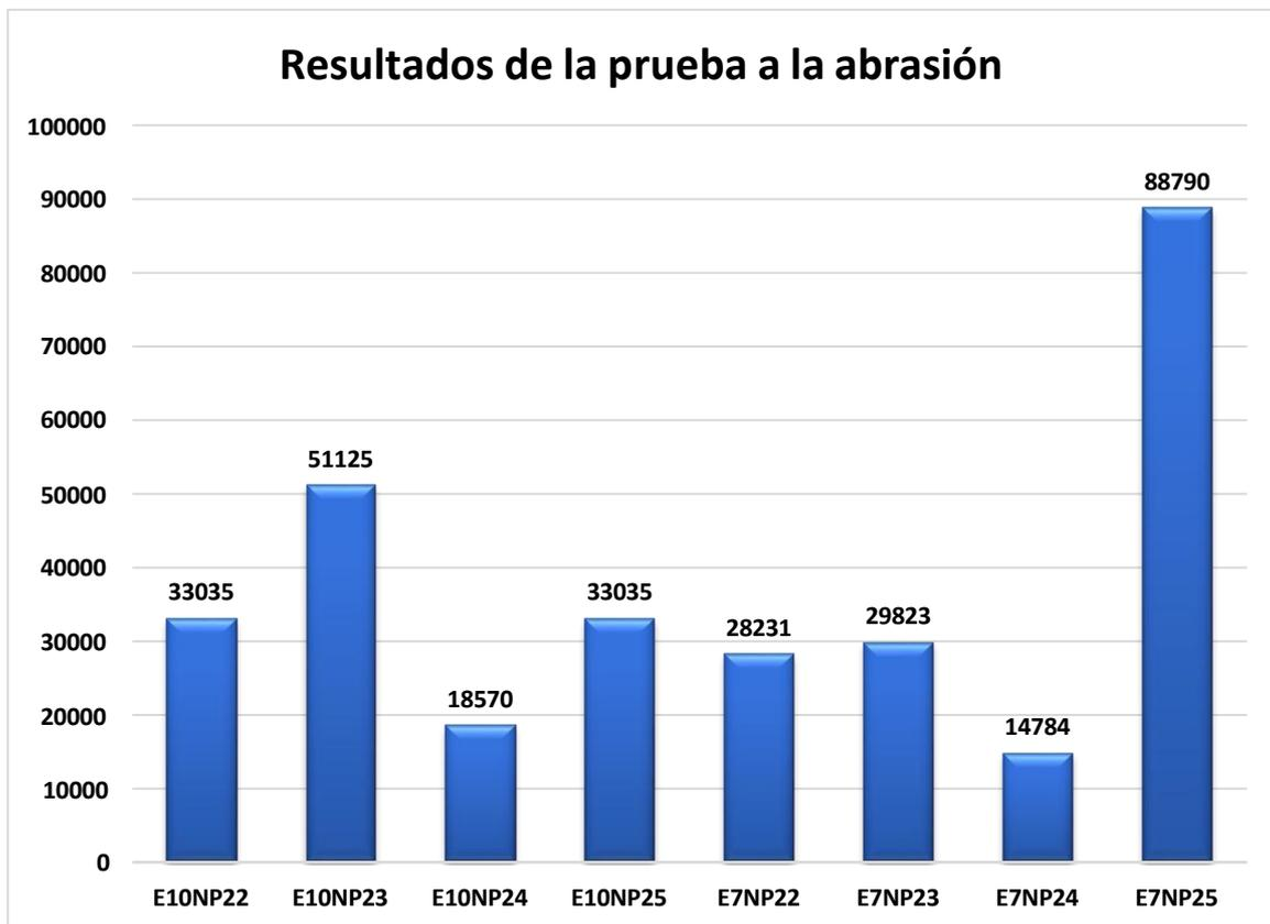
Nota: Resultados de la prueba resistencia a la abrasión donde E (Galga) y NP (Longitud de malla). Fuente: Propia.
