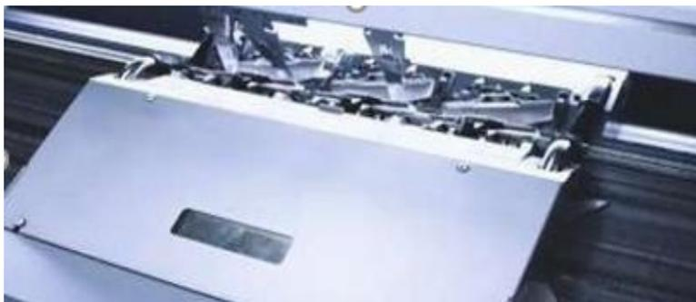
Nota: Sistema de tisaje en una máquina de tejido rectilínea.
