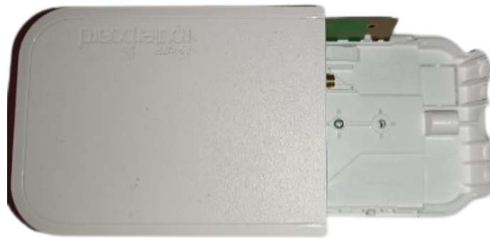
Figura 3.17: Gateway LR9 MikroTik.
