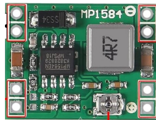
Figura 3.8: Regulador de voltaje MP1584 con una salida de 5V.
