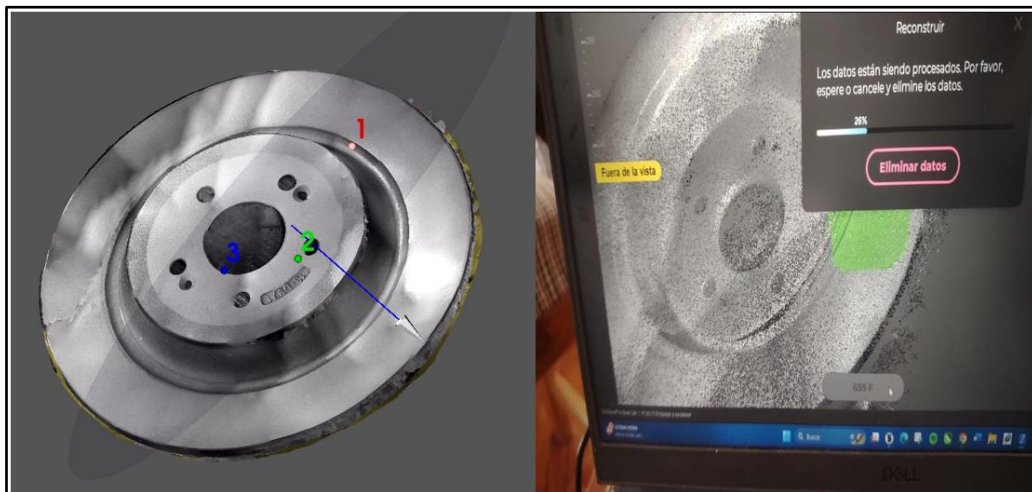
Figura 15. Escaneo del disco de freno comercial.
