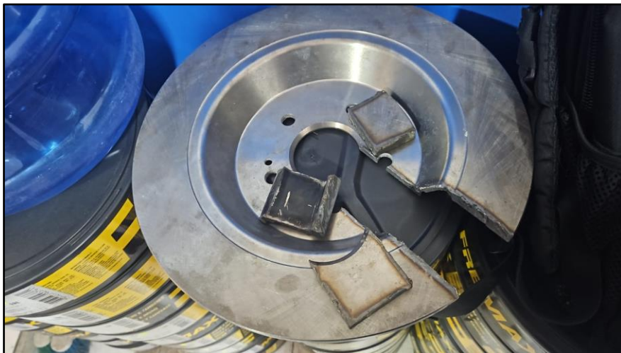
Figura 12. Extracción de muestra del disco de freno comercial
