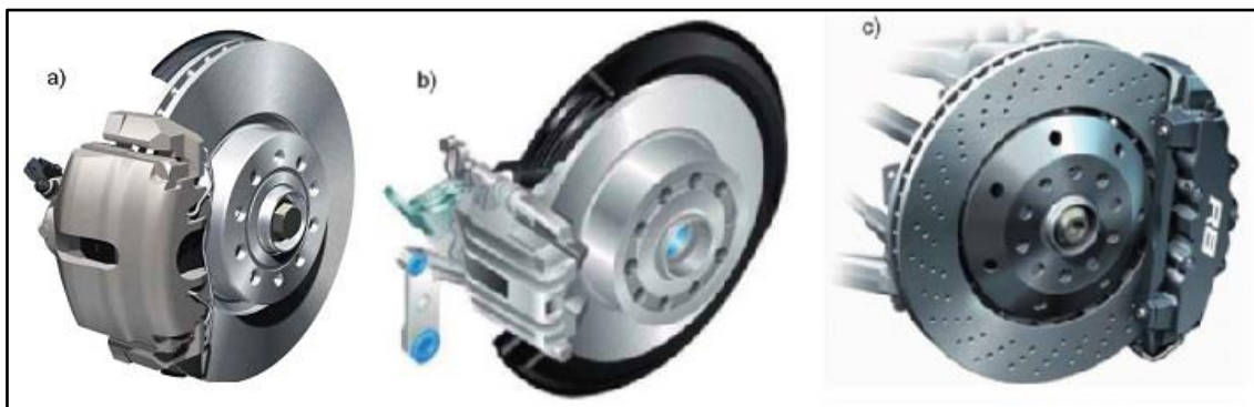
Figura 1. a) Disco ventilado, b) Disco macizo, c) Disco perforado
