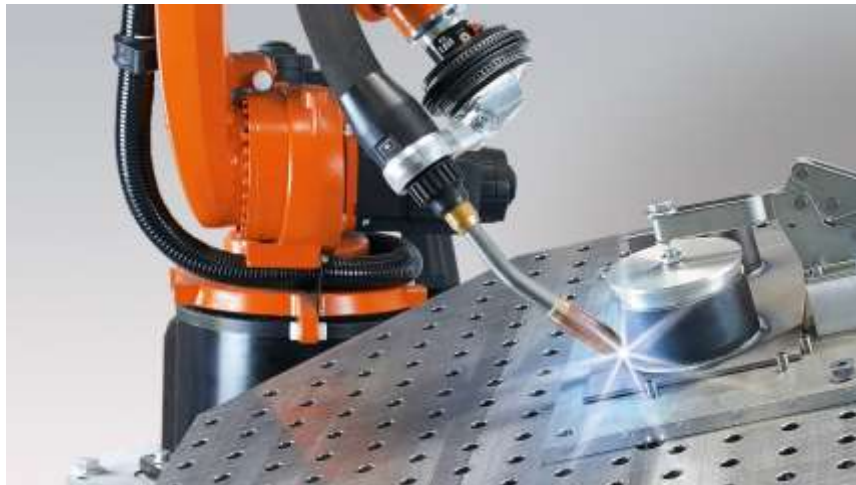
Fig. 2.2 Robot de soldadura en planta de montaje de autos de KUKA [15]
