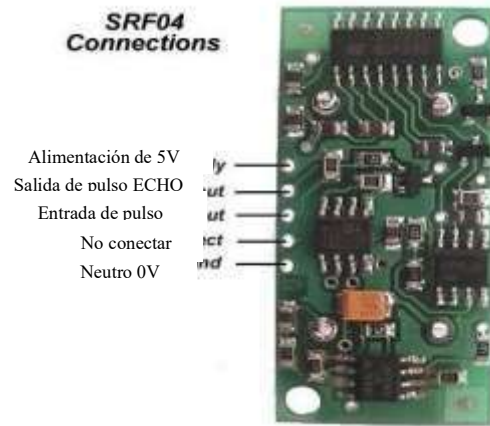
Fig. 2.16 Sensor ultrasónico SRF04 y sus conexiones [27]
