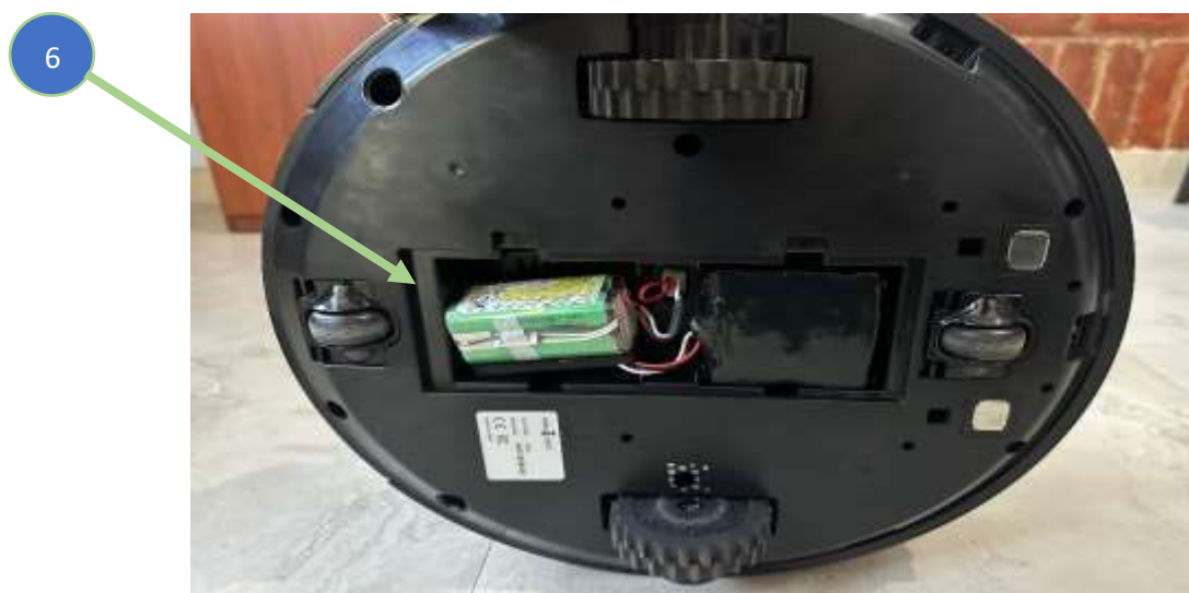
Fig. 4.3 Parte inferior de la plataforma Turtlebot2 y baterías integradas
