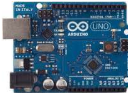
Fig. 2.26 Placa microcontrolada Arduino UNO [32]
