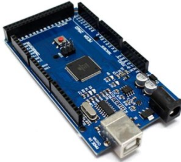
Fig. 4.5 Representación del microcontrolador Arduino MEGA [35]
