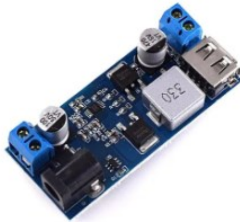
Fig. 4.10 Representación gráfica del módulo reductor de voltaje[39].
