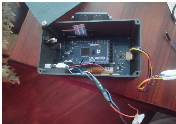
Fig. 4.51 Montaje componentes electrónicos a la carcasa del robot.
