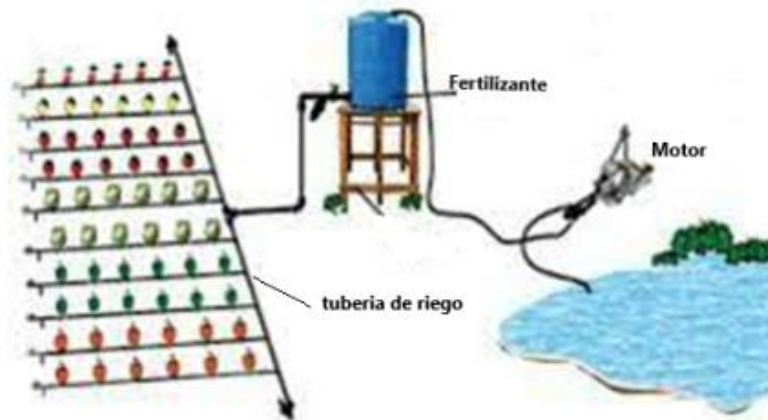
Fig. 1 Esquema de un sistema de fertirrigación por goteo
