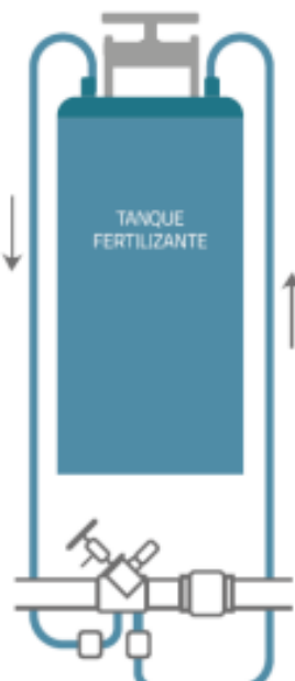
Fig. 5 Tanque de fertilización manual
