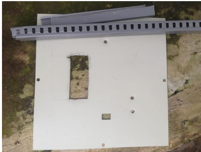
Fig. 26 Preparación para el ensamblaje del panel frontal del gabinete
