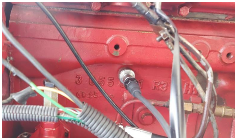
Figura 23. Ubicación de Acelerómetro dentro del Bloque de Motor
