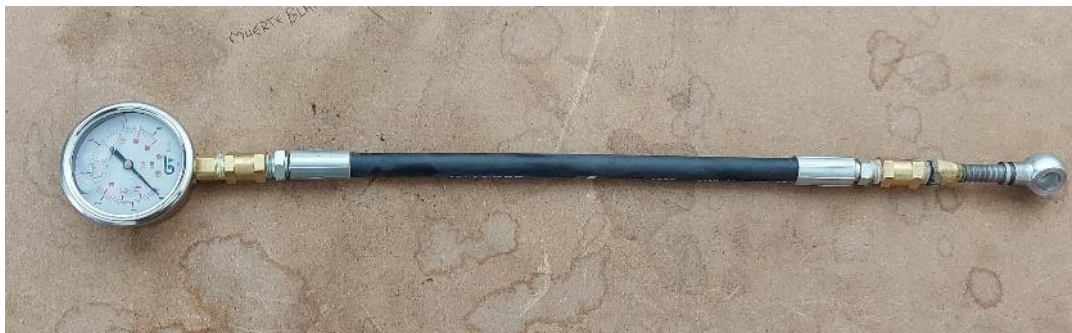
Figura 19. Manómetro de Medición de Presión dentro de la Bomba de Combustible
