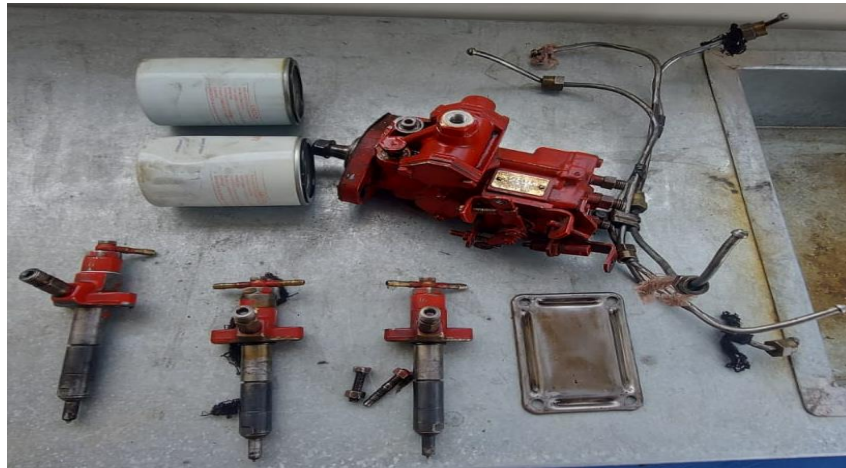
Figura 41. Desmontaje de Bomba e Inyectores
