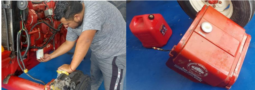
Figura 44. Limpieza de la Bomba de Combustible
