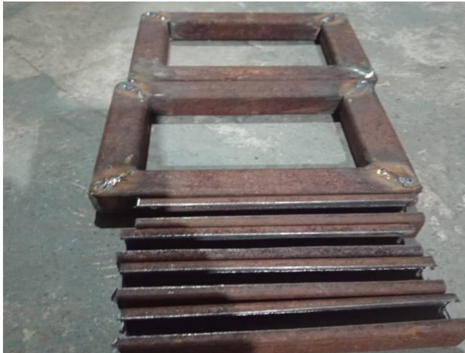
Fig. 4.0.36 Cortes de tubo mediante la máquina tronzadora.
