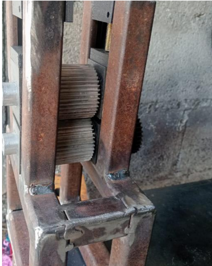
Fig. 4.0.39 Estructura metálica de la máquina plisadora.
