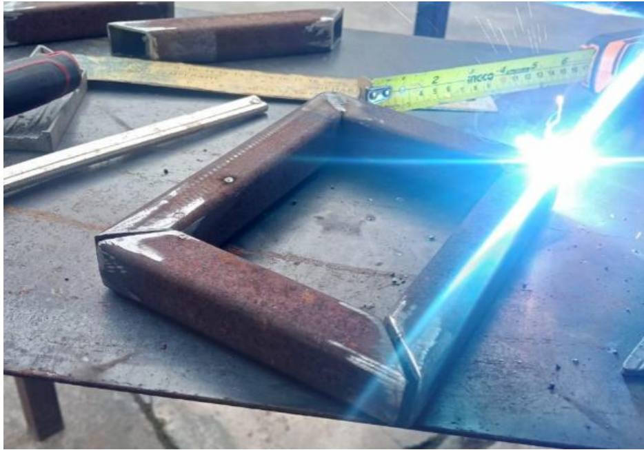
Fig. 4.0.37 Proceso de soldadura MIG empleado para la unión permanente de los perfiles tubulares.
