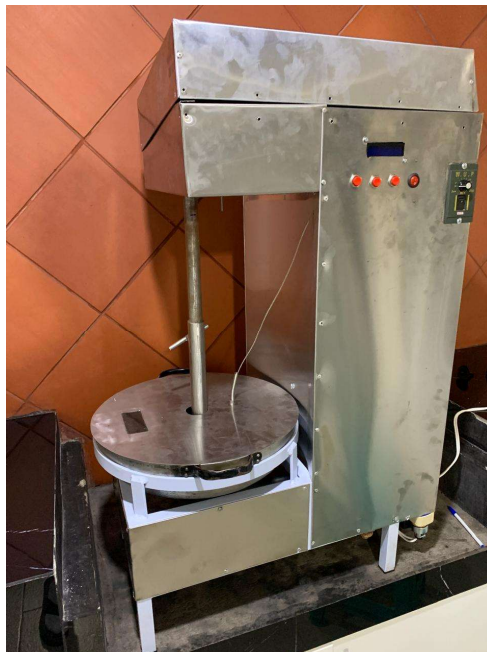
Fig. 4.28 Prototipo de tostadora de maíz suave Pruebas de funcionamiento
