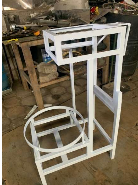
Fig. 4.26 Estructura metálica con recubrimiento protector
