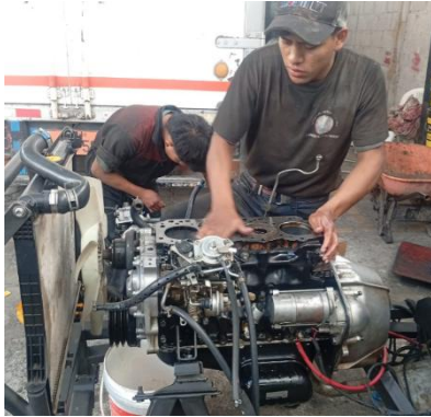
Figura 67 Mantenimiento Correctivo al motor 4JB1
