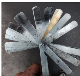
Figura 13 Juego de galgas utilizado en el estudio
