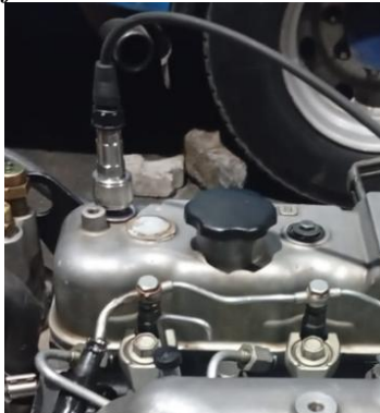
Figura 16 Fijación del sensor en el motor Isuzu NHR
