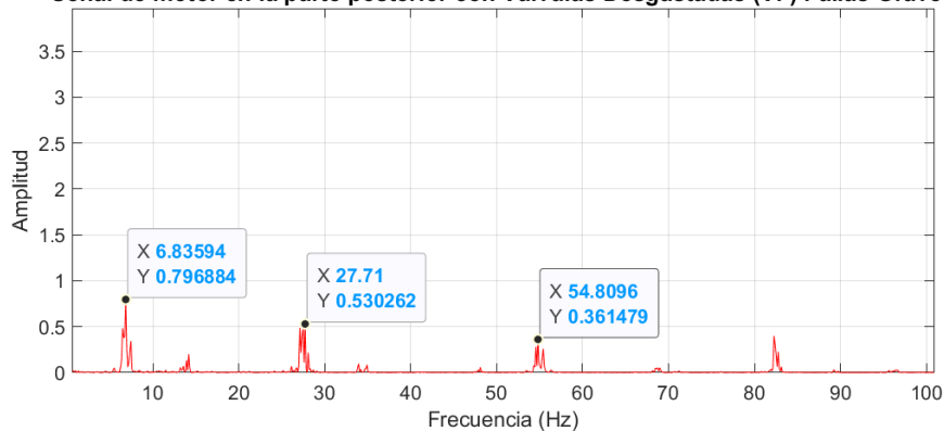
Figura 46 Señal del en Parte Posterior con VF Señal de motor en la parte posterior con Valvulas Desgastadas (VF) Fallas Graves
