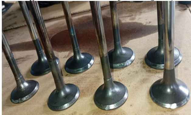
Figura 24 Válvulas modificadas (falla)
