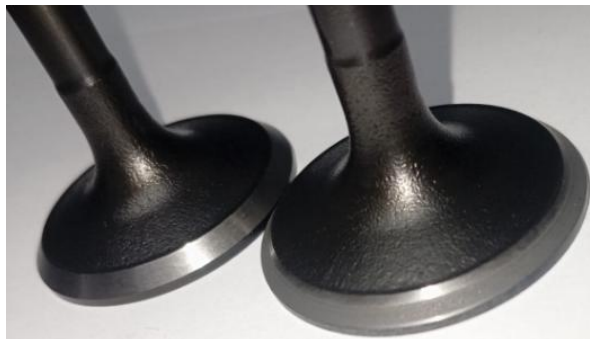
Figura 27 Asentamiento de válvula
