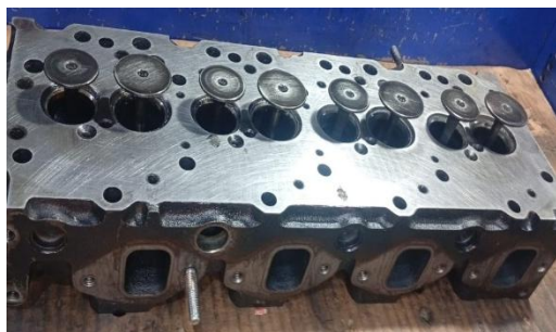
Figura 23 Válvulas que cumplieron su vida útil
