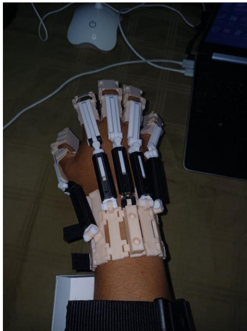
Fig. 4. 25 Prototipo final de órtesis activa para rehabilitación de parálisis radial
