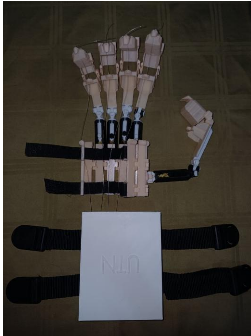
Fig. 4. 25 Prototipo final de órtesis activa para rehabilitación de parálisis radial
