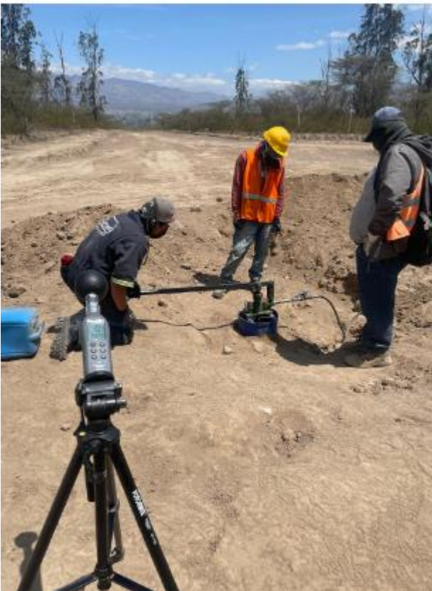
Fotografía 5. Medición de índice WBGT en actividad laboral de pruebas de presurización
