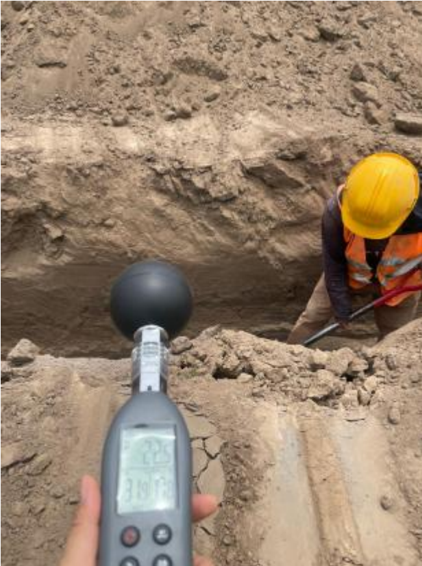
Fotografía 1. Medición de índice WBGT en actividad laboral de rasanteo.
