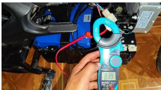
Figura 54. Medición del voltaje máximo de la batería HV.
