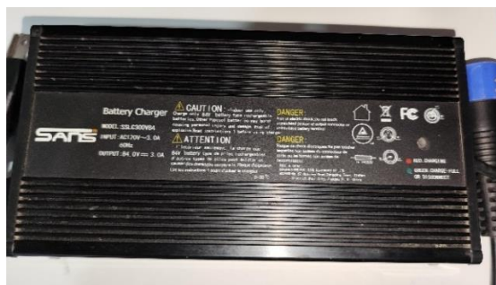
Figura 47. Cargador empleado en el ensayo estático.
