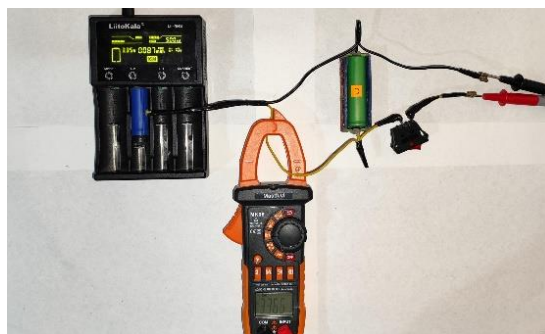
Figura 31. Medición de parámetros para estimar la Resistencia Interna.
