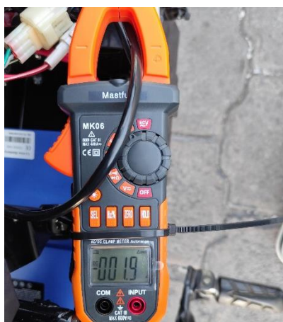
Figura 55. Medición de corriente durante el ensayo dinámico.
