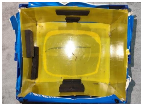
Figura 81. Interior de la carcasa plástica del paquete de baterías.
