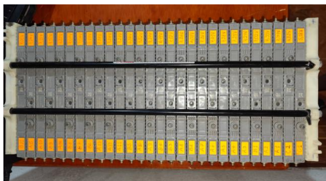
Figura 36. Etiquetado de módulos de Ni-MH en la batería HV descartada.
