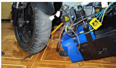
Figura 44. Extracción de la batería HV de la motocicleta.
