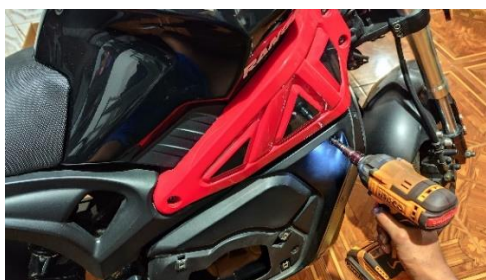
Figura 43. Desmontaje del carenado de la motocicleta.
