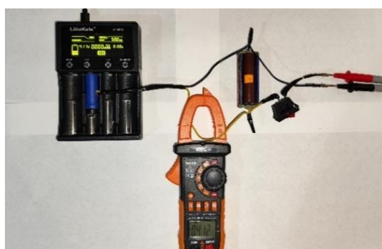
Figura 30. Montaje de equipos para prueba de SOC.
