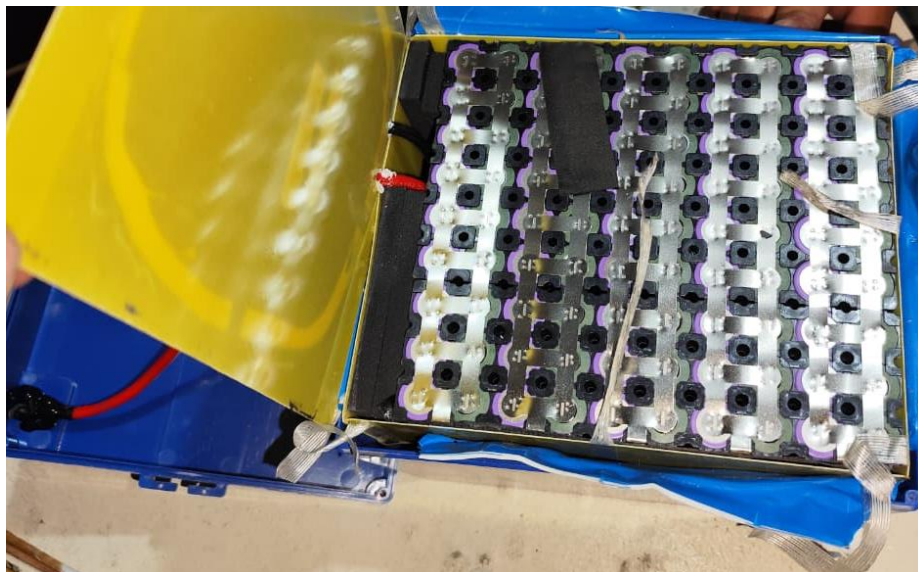
Figura AI 1. Desmontaje de los elementos aislantes de la batería HV.
