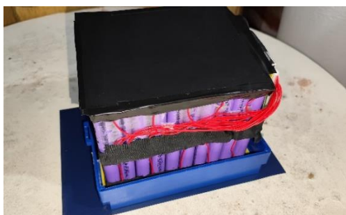
Figura 45. Paquete de celdas 18650 que conforman la batería HV.
