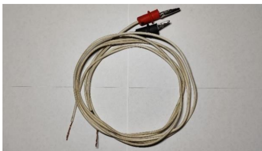
Figura 46. Cable utilizado para la fase de carga de la batería HV.
