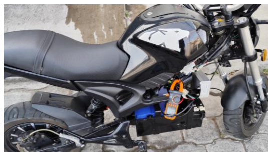
Figura 53. Instalación de los equipos de medición en el ensayo dinámico.
