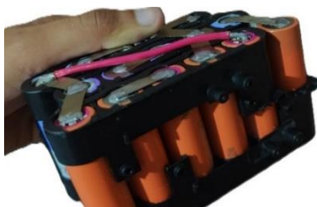
Figura 24. Estructura de un paquete de celdas 18650.
