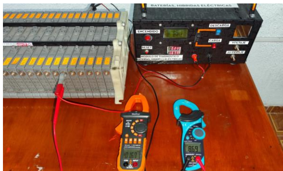
Figura 40. Equipo empleado para las pruebas piloto en módulos de Ni-MH.
