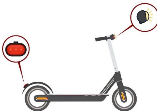
Figura 24. Luces obligatorias de vehículos de movilidad personal
