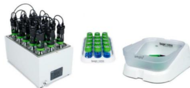
Figura 2. Sistema automático de prueba de potencial de metano
