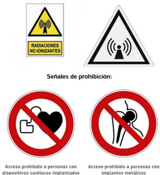
Ilustración 1 Señales de advertencia en la habitación
